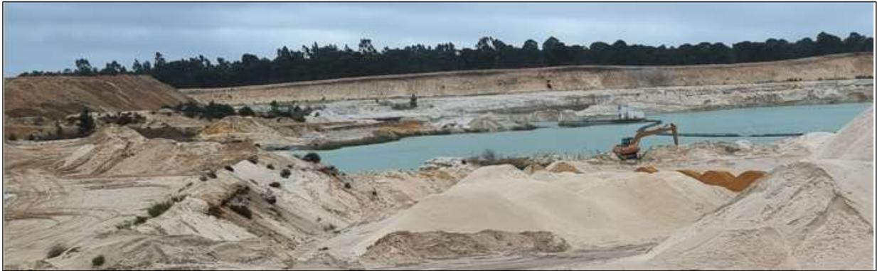
**Figura 11: Bloco A, vendo-se, ao fundo, a draga e o mineraduto de transporte da polpa e em primeiro plano o desmonte com giratória**
