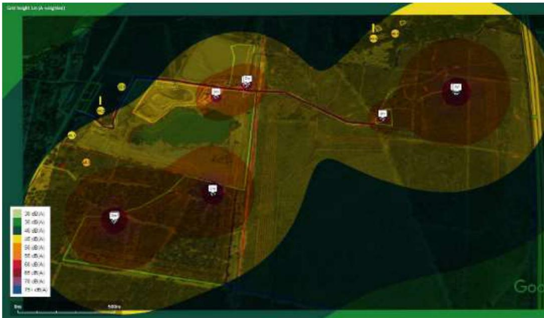
Figura 27: Modelação do ruído particular da laboração da Mina (operação simultânea nos blocos A, B, C e D) – período diurno.
