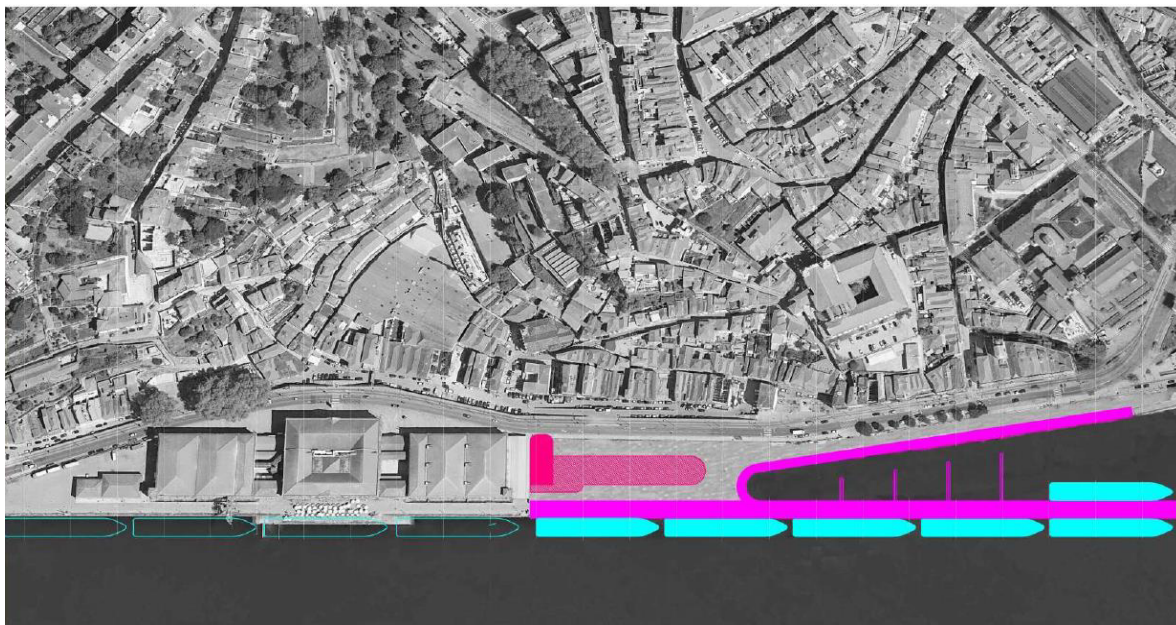
Figura 3 – Variante 2 da Alternativa Proposta. Novo Edifício do Terminal, reperfilamento do molhe, criação de extensão do molhe, abertura de nova doca. Capacidade para cinco mais uma para cinco embarcações e expansão efémera a mais quatro embarcações. Na pequena marina a criar na doca poderão ser ancoradas aproximadamente dois terços das embarcações propostas para a intervenção no Cais do Cavaco, acrescidas das embarcações da Polícia Marítima.
