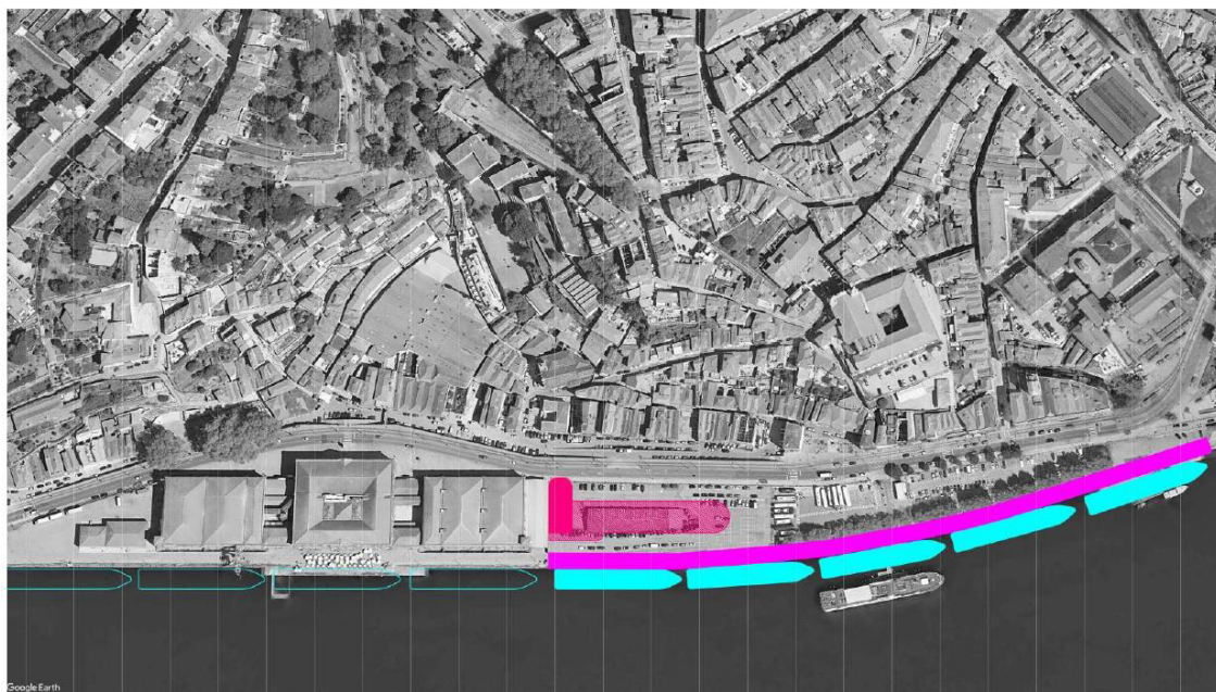
Figura 2 – Variante 1 da Alternativa Proposta. Novo Edifício do Terminal e reperfilamento domolhe para cinco embarcações e expansão efêmera a mais quatro embarcações.
