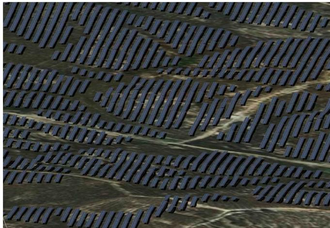
Figura 4.7 – Simulação dos Painéis fotovoltaicos que acompanham a morfologia do terreno
