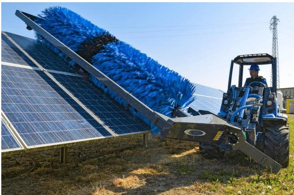
Fotografia 4.33 - Exemplo do equipamento para limpeza dos painéis fotovoltaicos
