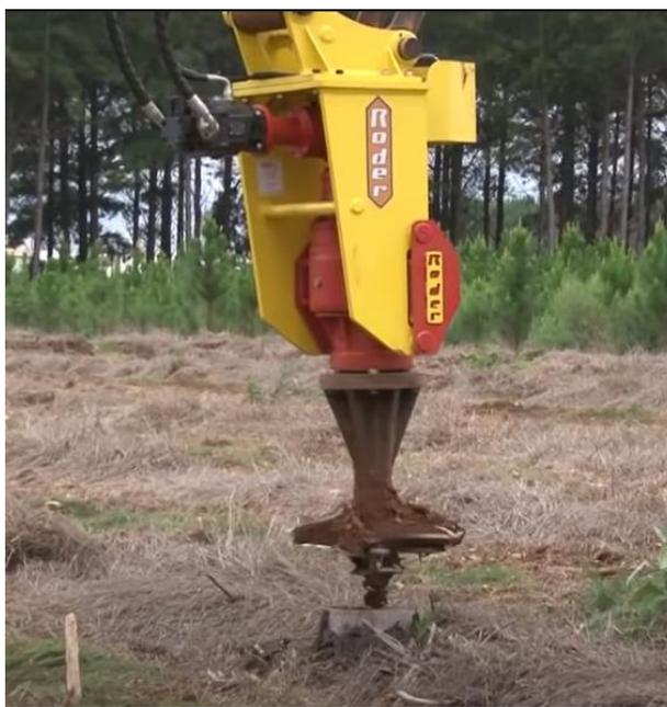
Figura 4.12 - Exemplo de descepador (Fonte: <https://www.youtube.com/watch?v=sGMdbP2S0zs>)
