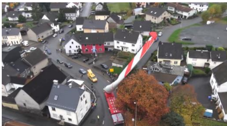
Figura 2 - Transporte de pás por blade lifter em centros urbanos ( https://www.engenhariacivil.com/sistema-transporte-pas-turbinas-eolicas ).
