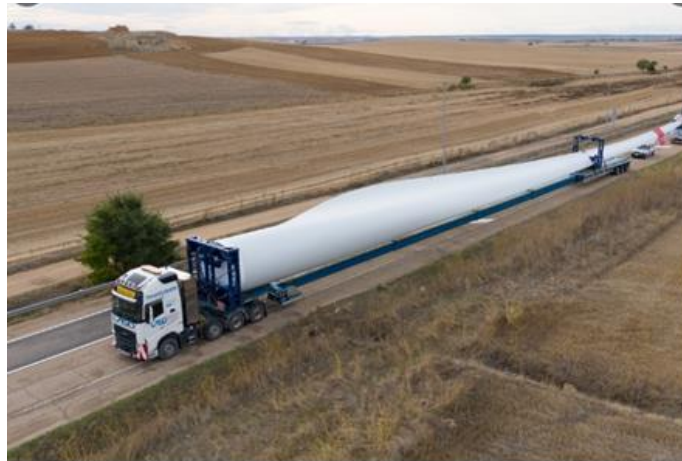
Figura 1 - Transporte convencional de pás.
