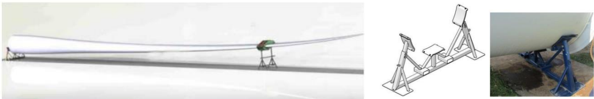
Figura 8 - Detalhe da estrutura metálica para armazenamento temporário das pás.
