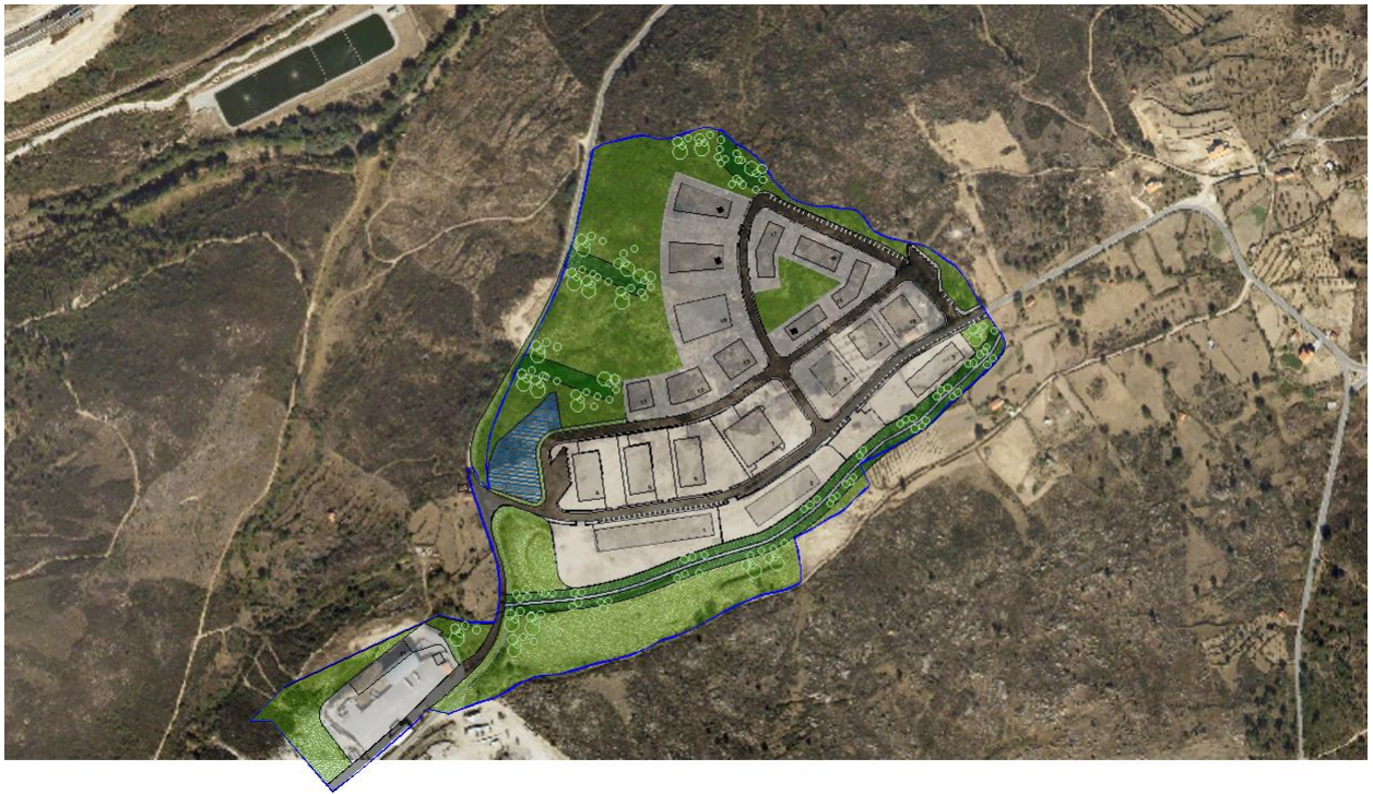
FIGURA 3 - PLANTA SÍNTESE DO ESTUDO PRÉVIO DA ZONA INDUSTRIAL DE JUNCAIS
