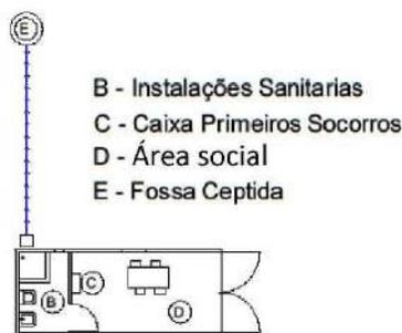
**Figura A12** – Pormenor da ligação das instalações sanitárias à fossa séptica estanque.
