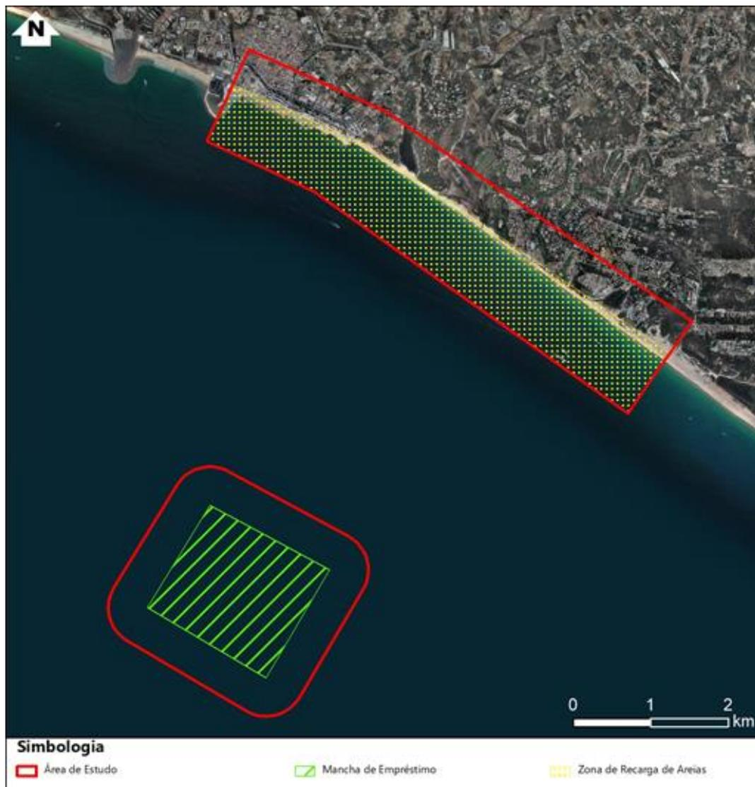
Figura 1.1 – Representação das áreas de intervenção – recolha e deposição de sedimentos dragados (extraído do EIA)
