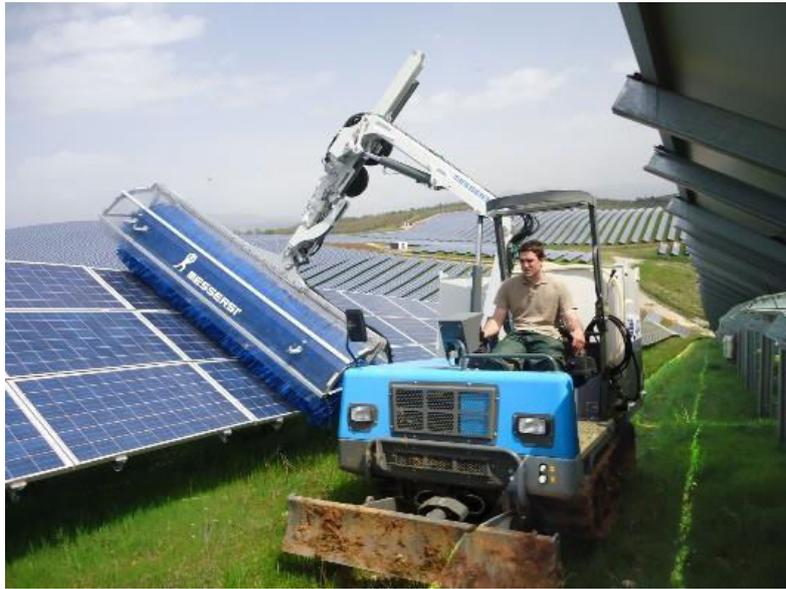
Fotografia 4.11 – Exemplo do equipamento para limpeza dos painéis fotovoltaicos
