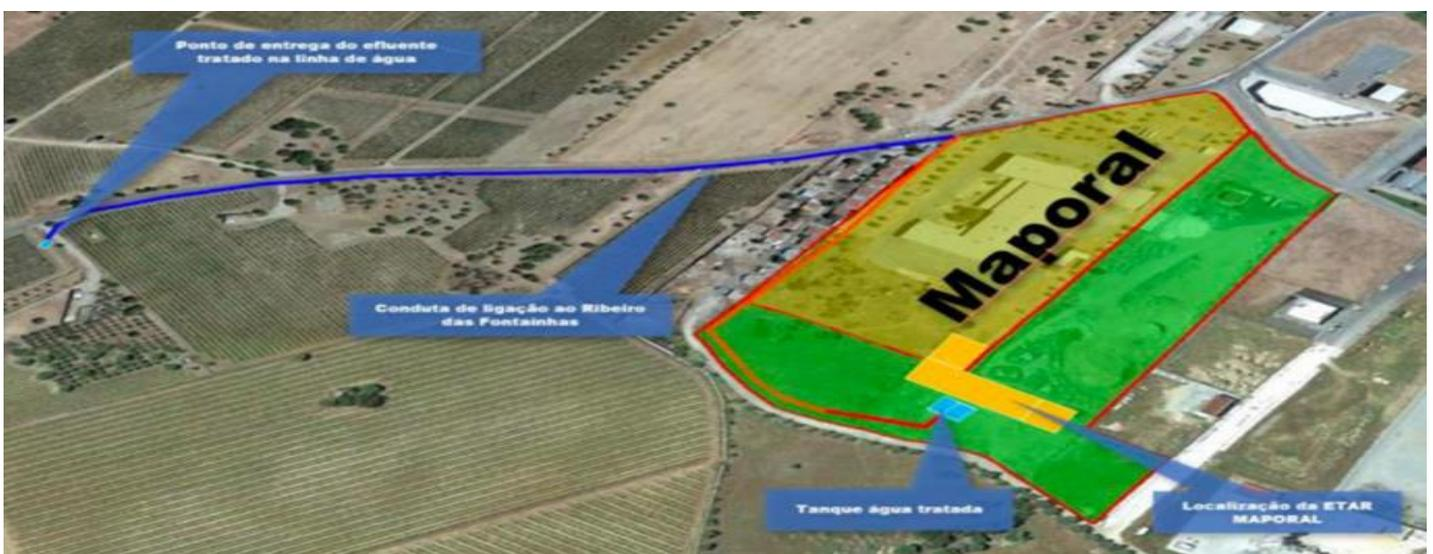
Figura 4 - Traçado da conduta de descarga do efluente tratado
