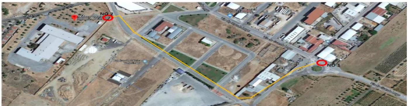
Figura 3 - Traçado da conduta de abastecimento de água
