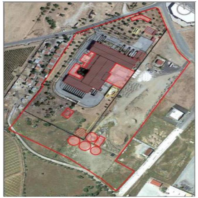
Figura 2 - Área do Matadouro com Projeto: Vermelho, a construir / Amarelo, a demolir
