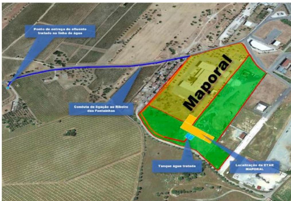
Figura 2 - Localização da ETAR e representação da conduta de ligação ao local de descarga. Fonte: proponente.
