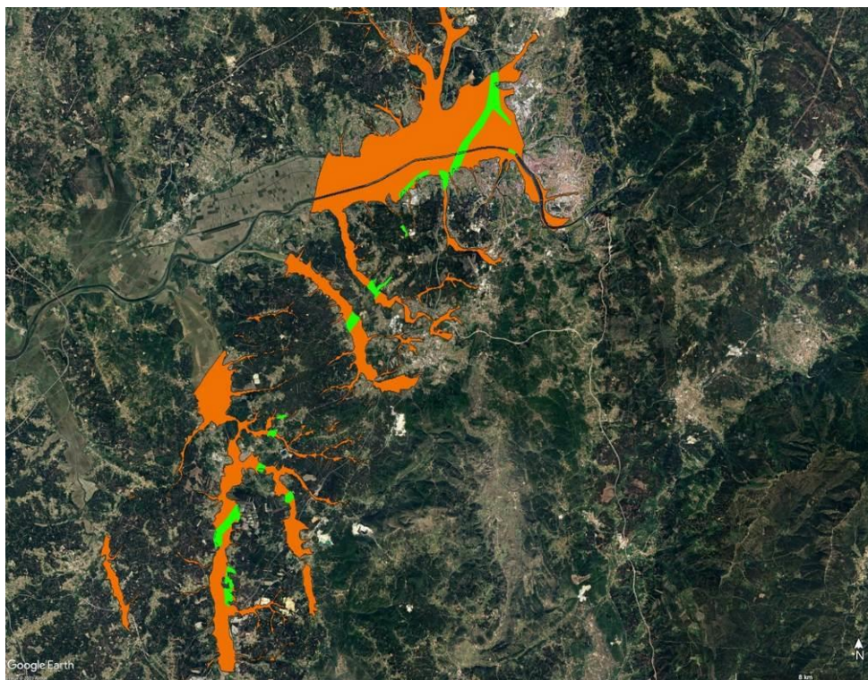
Figura 1 – Aluviões na área do projeto e envolvente na bacia do Mondego. Cor de laranja: aluviões; verdes: áreas de estudo obtidas pela interseção das aluviões com o corredor de 400 m centrado no eixo do traçado.
