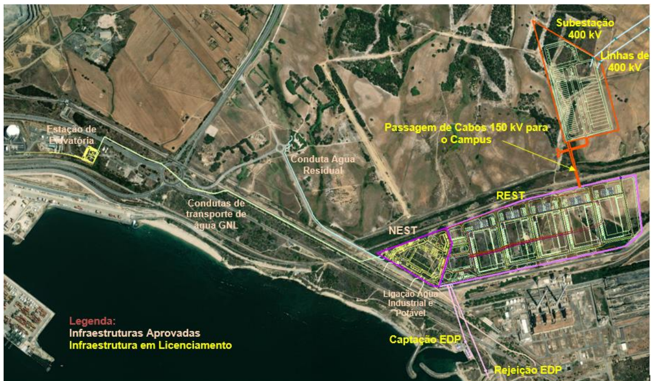
Figura 6 – Esquema Geral do projeto do Data Center (NEST e REST).
