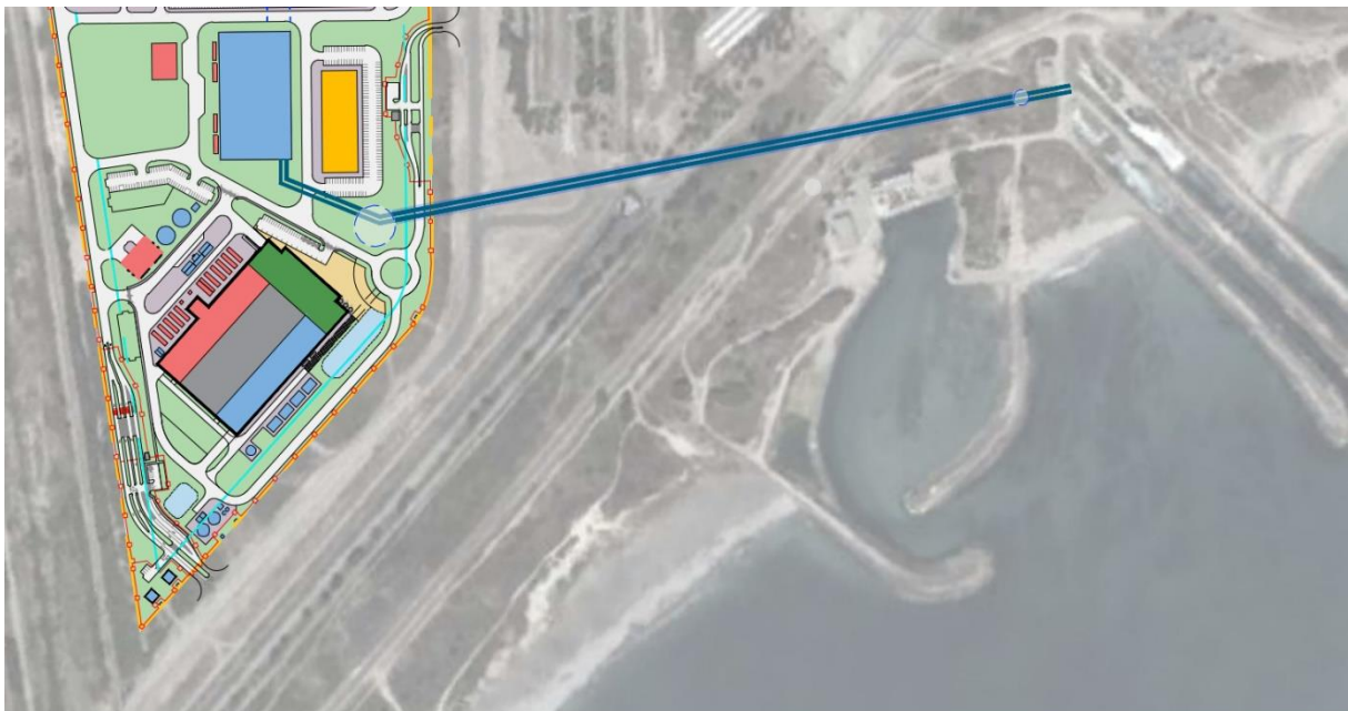
Figura 17 - Conduitas de rejeição de água a construir até às infraestruturas existentes da Central Termoelétrica de Sines.
