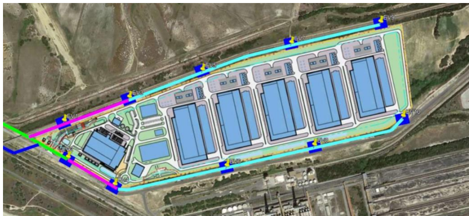
Figura 35 – Representação da expansão dos caminhos de cabos do NEST para o REST e identificação das zonas de entradas (EV).
