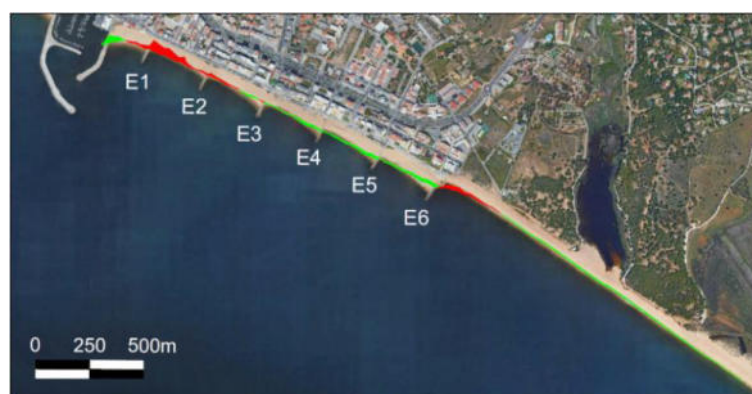
Figura 4. Áreas de erosão e acreção no ano 50 da simulação, para o cenário 6. (Fonte: EELC, 2021)
