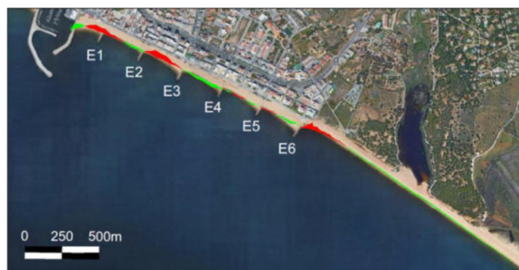
Figura 5. Áreas de erosão e acreção no ano 50 da simulação, para o cenário 8. (Fonte: EELC, 2021)
