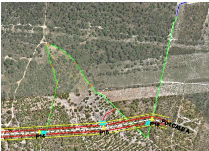
Figura 4.25 - Acessos aos apoios P14, P15 e P16
