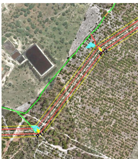
Figura 4.19 - Acessos aos apoios P11 e P12
