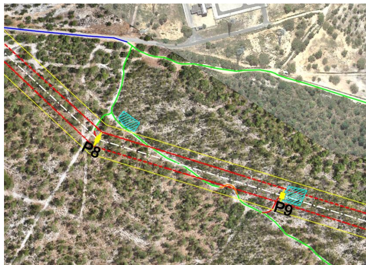
Figura 4.14 - Acessos aos apoios P8 e P9
