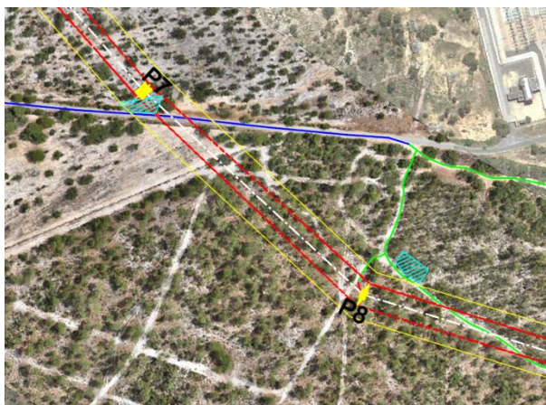
Figura 4.12 - Acessos aos apoios P7 e P8
