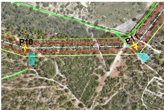
Figura 4.18 - Acessos aos apoios P10 e P11
