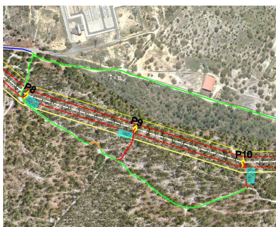
Figura 4.14 - Acessos aos apoios P8, P9 e P10
