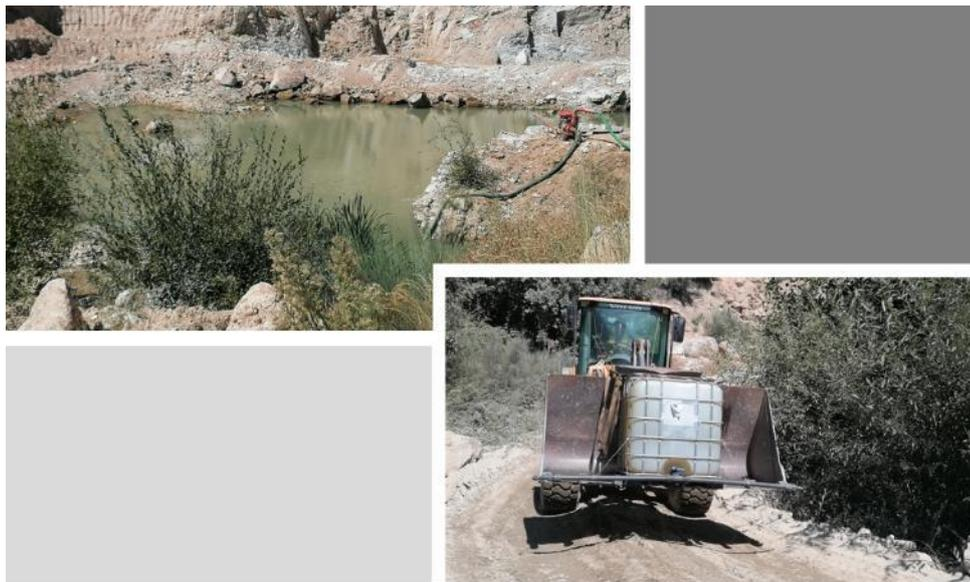
**Figura 16 – bomba para retirar a água da corta do Núcleo III e rega dos acessos**
