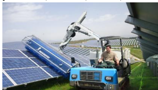
Exemplo do equipamento para limpeza dos painéis fotovoltaicos
