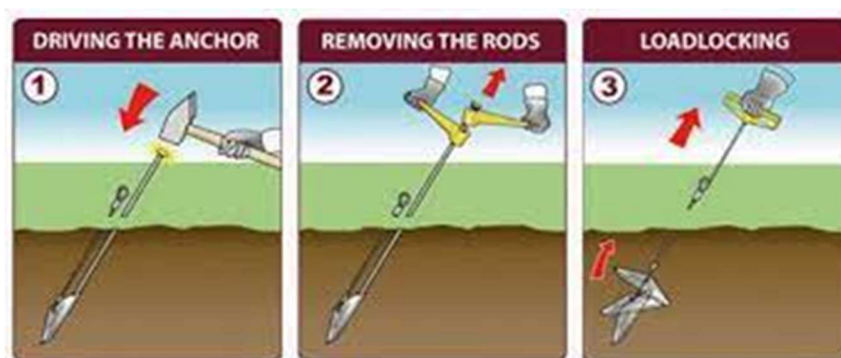
Figura 10: Instalação das espigas de Amarração
