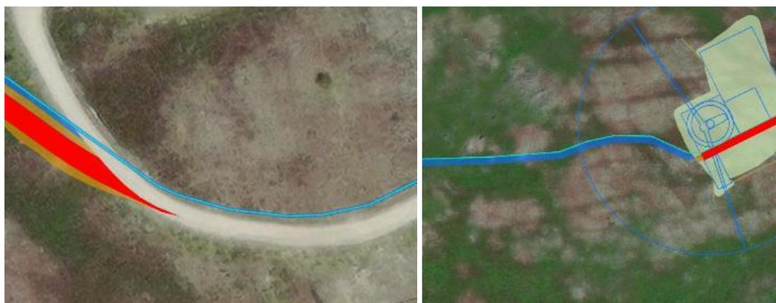
Figura 137 – Esquema de implantação da vala de cabos.
