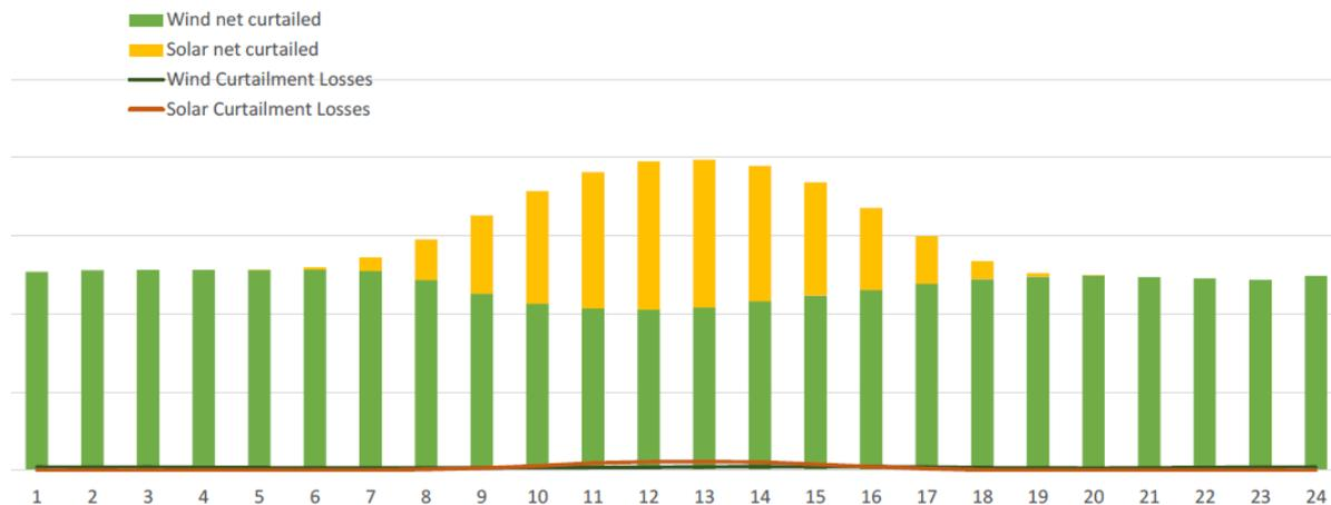
Figura 2 – Diagrama diário de produção de um sistema híbrido (eólico + fotovoltaico)
