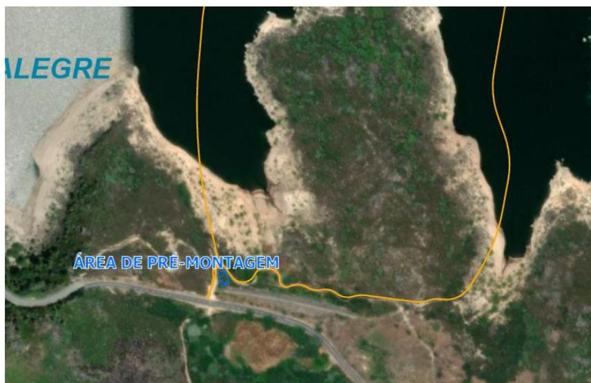
Figura 134 – Enquadramento da implantação das áreas de apoio à montagem das ilhas de painéis fotovoltaicos (sem escala).
