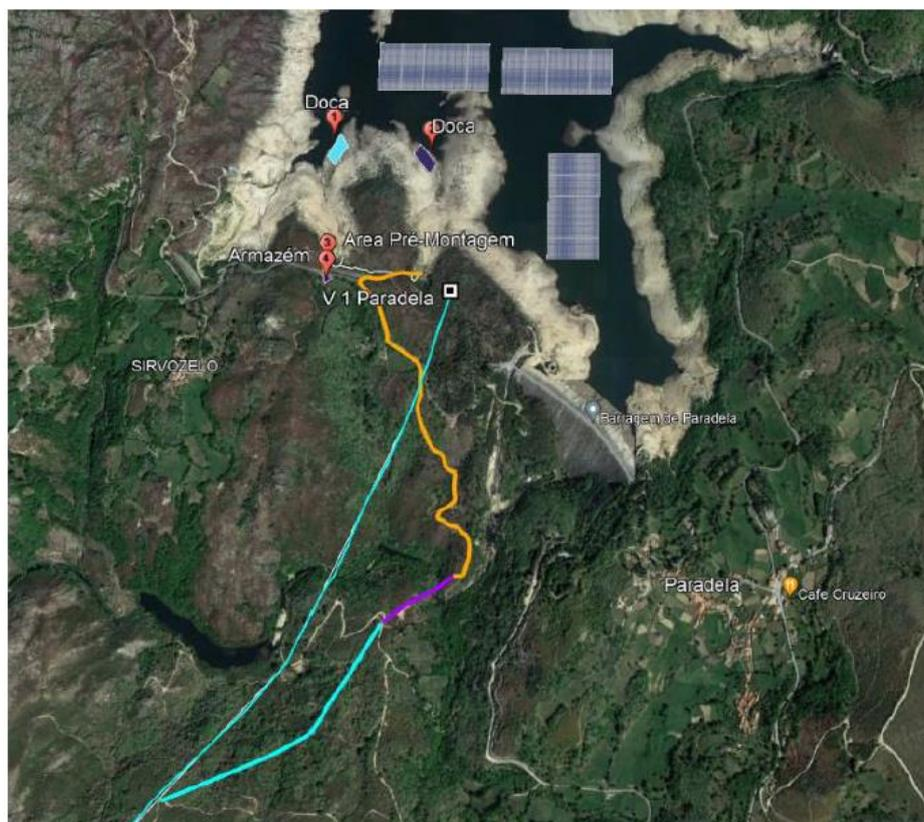
Figura 6 – Extrato do estudo de Alternativas de acesso às zonas de montagem, operação e manutenção da futura Central Solar Fotovoltaica Flutuante de Paradelas. (Zona de montagem 1/Doca 1 e zona de montagem 2/Doca 2). As ilhas representadas correspondem a uma versão anterior e o traçado a azul corresponde a uma versão anterior do projeto da LE (abandonada em função do EGCA).
