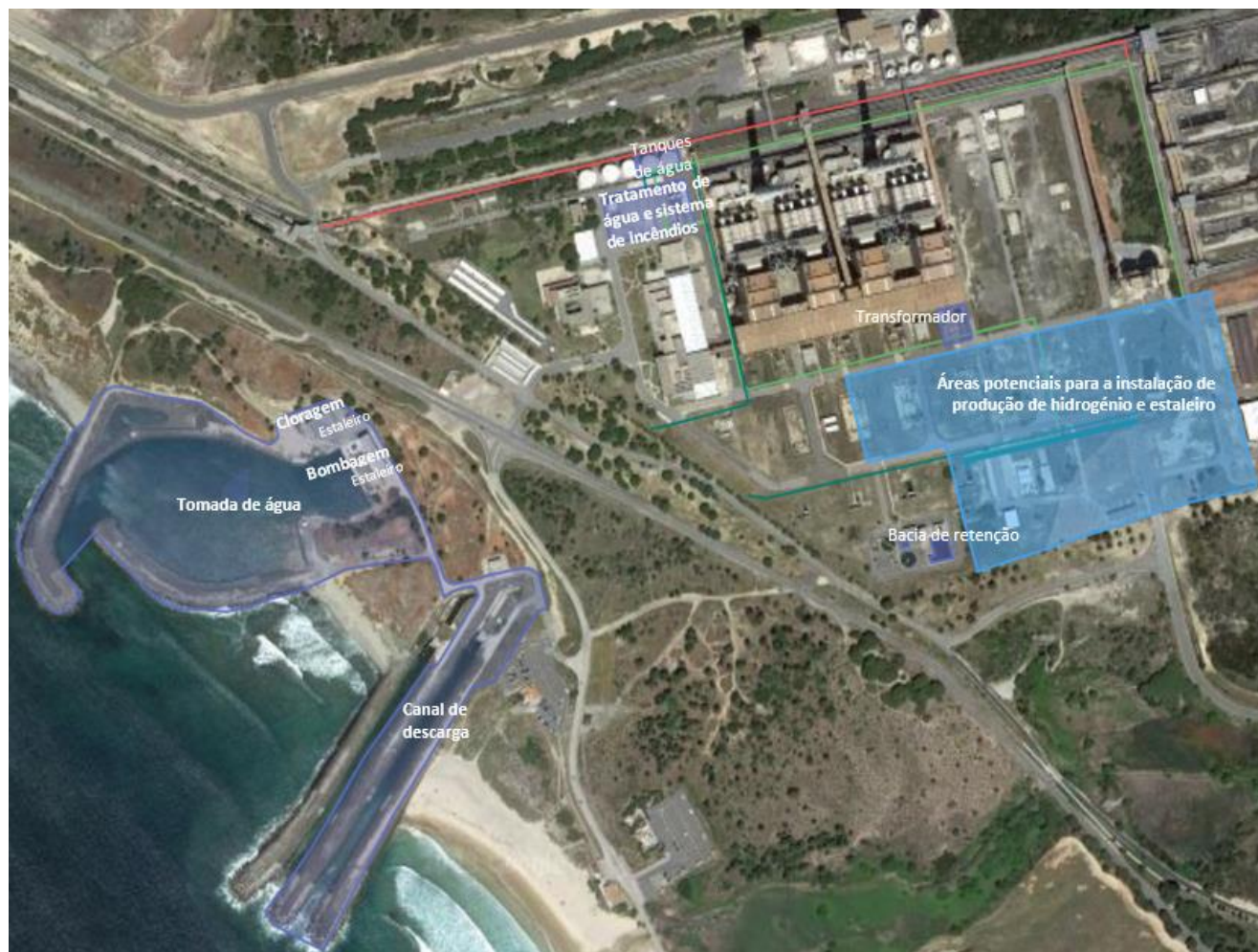
Figura 4 – Localização, sobre fotografia aérea, das áreas onde ficará implantada a nova instalação de produção de H 2 Verde e estaleiro, e dos edifícios/estruturas da CTS a reutilizar
