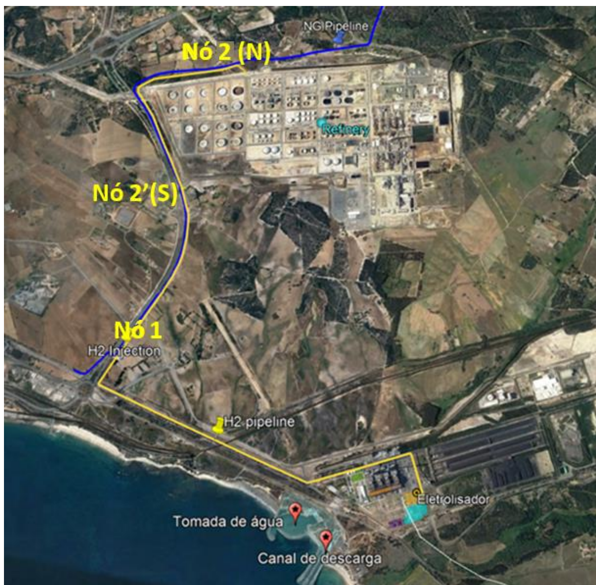
Figura 9 – Traçado preliminar do pipeline dedicado de H 2 (opcional), a amarelo. A azul, o gasoduto de GN da REN Gasodutos
