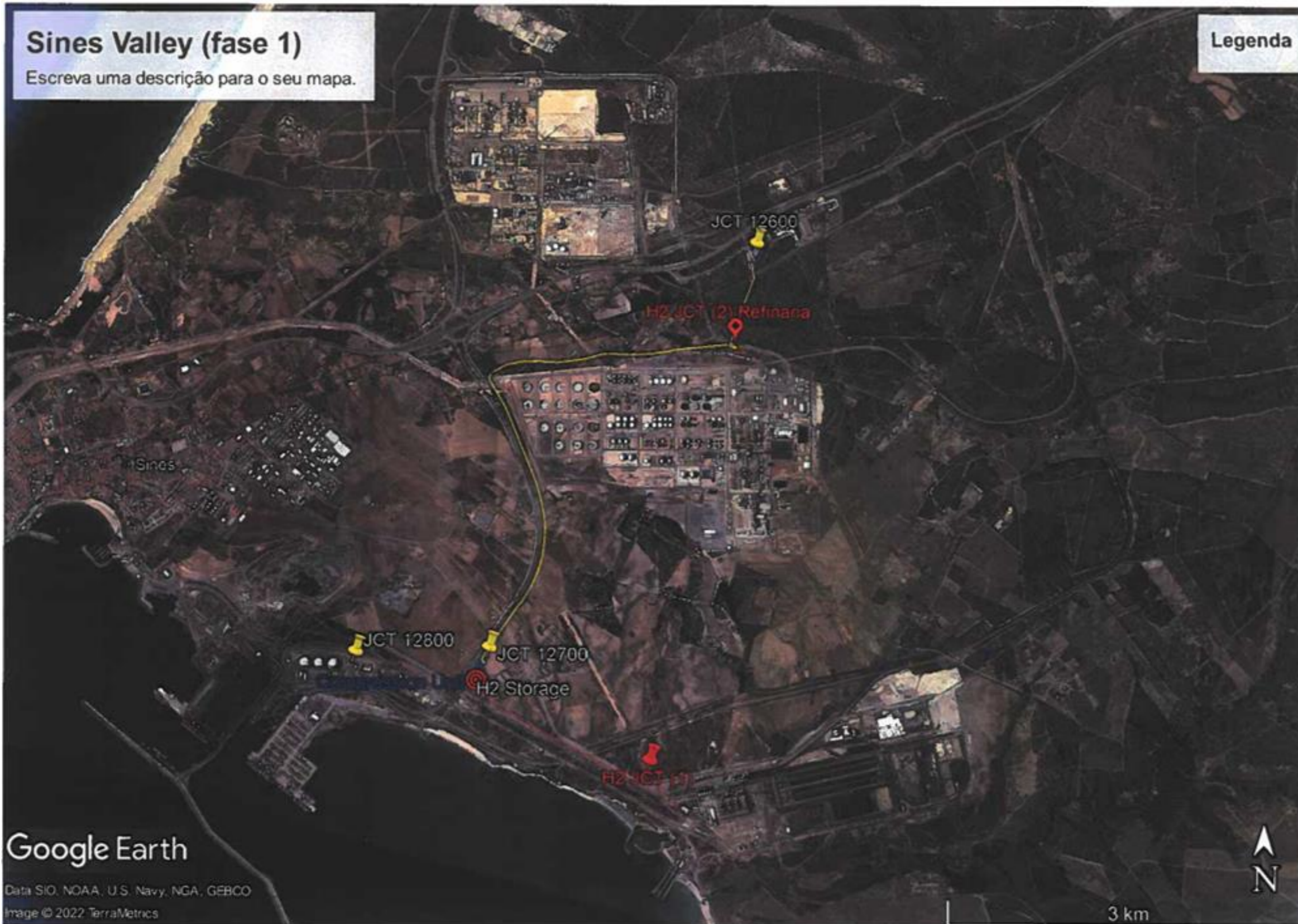
Figura 3.4 – Sines Valley (Fase 1): os pontos a vermelho representam mais de implantação de estações de junção (H2 JCT (1)) a sul e (H2 JCT (2)) a norte da refinaria. A nascente, junto à estação de junção JCT 12700 de GN da RNTG (a amarelo), encontra-se um círculo vermelho que indica uma armazenagem de Hidrogénio (H 2 Storage)
