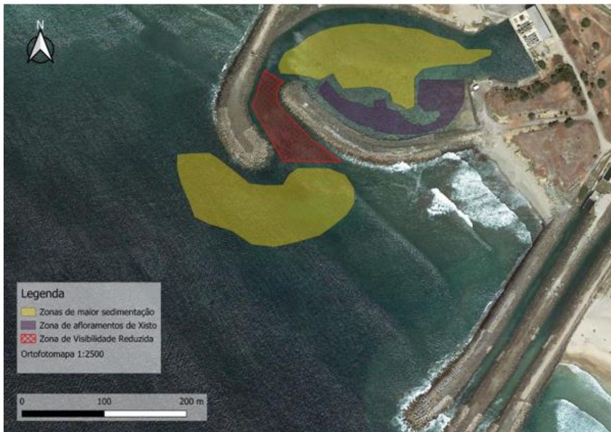
Figura 5.147 – Zonamento. Zona de visibilidade reduzida e Zonas de maior sedimentação e de afloramentos de xisto, sobre fotografia aérea.
