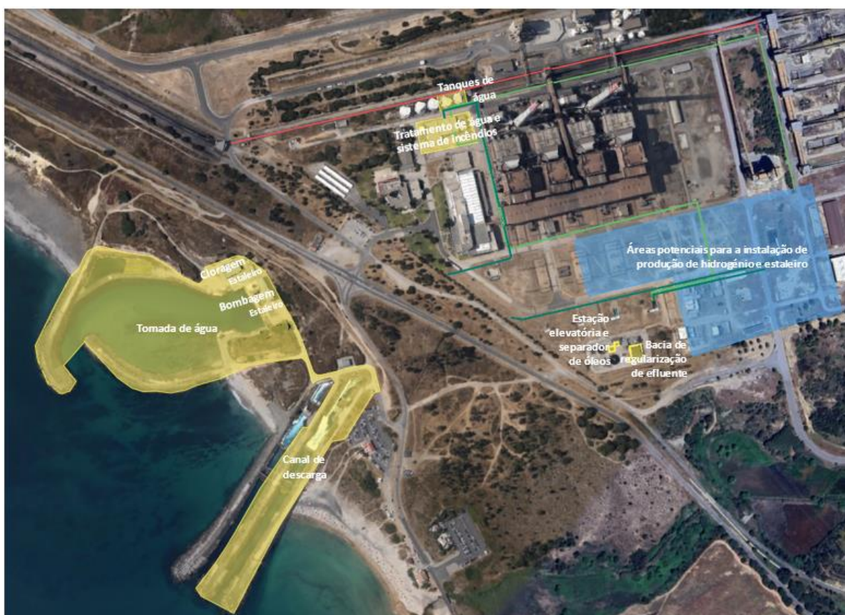
Figura 3.3 – Localização, sobre fotografia aérea, das potenciais áreas a ocupar pelo projeto GH2A e das Infraestruturas da CTS a reutilizar: a azul: a instalação de produção de H 2 e o estaleiro principal localizar-se-ão dentro da mancha azul. A amarelo: edifícios/estruturas da CTS a reutilizar e estaleiros de apoio
