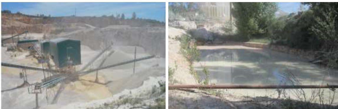
Figura III.28 – Unidade de britagem e bacia de decantação de finos existente na pedreira.
