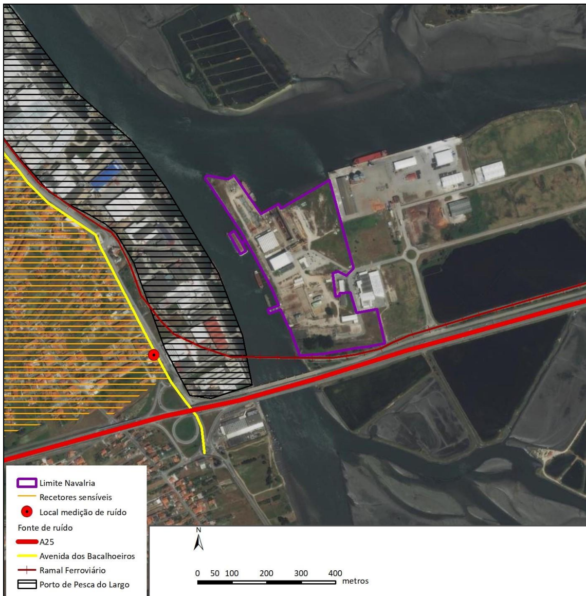
Figura 4.14- Identificação das fontes sonoras e recetores sensíveis e localização do ponto de medição de ruído na envolvente próxima à área do projeto.
