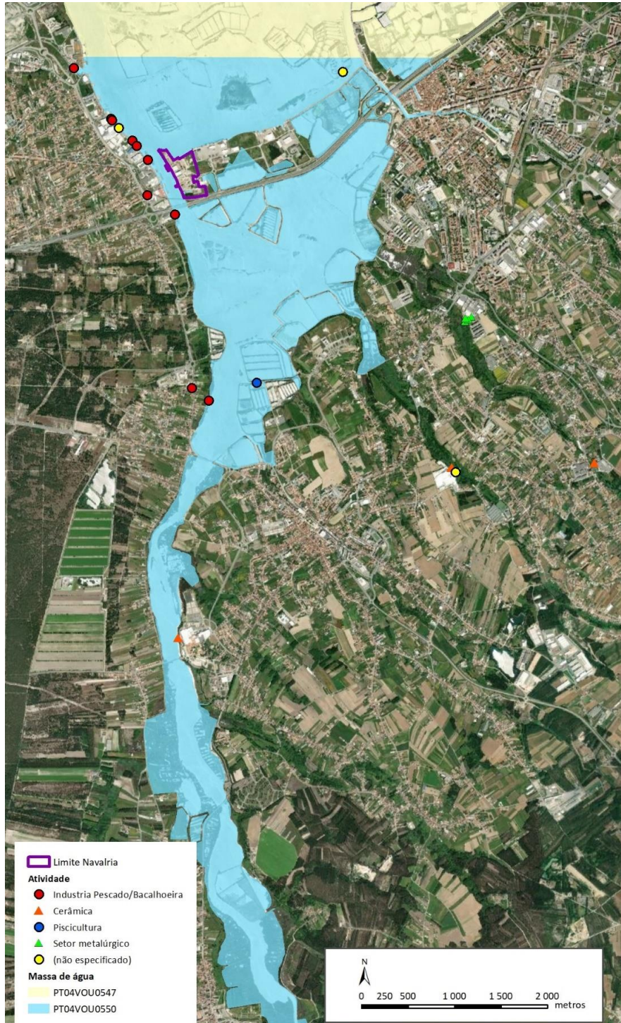
Figura 4.17- Enquadramento do projeto na massa de água PT04VOU0550 e localização dos pontos de rejeição de águas residuais na referida massa de água (Fonte: ARH Centro).
