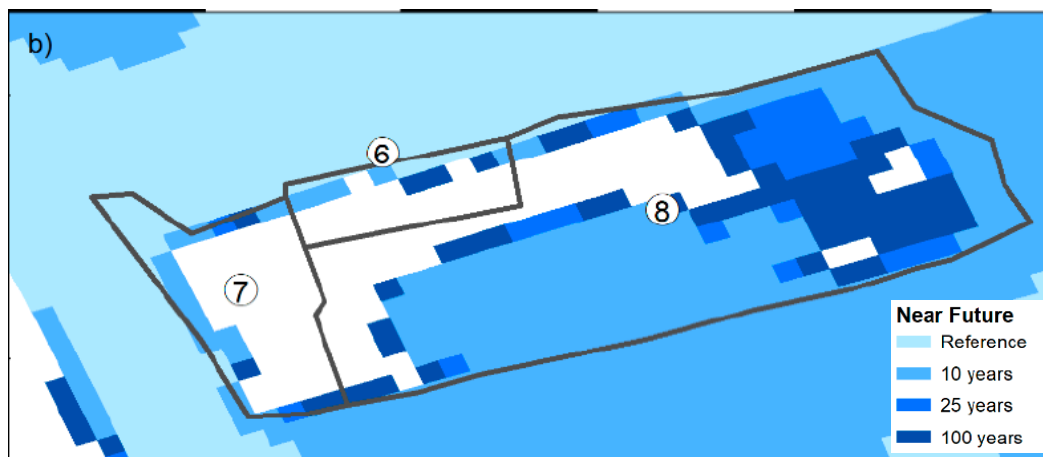
Figura 5.3- Extensão das áreas inundadas no cenário de futuro próximo (2026-2045) em situações extremas para os períodos de retorno de 10, 25 e 100 anos. A zona 7 corresponde às instalações concessionadas à Navalria. Adaptado de Ribeiro et al. , 2021.
