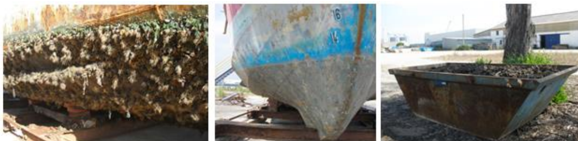
Figura 3.16- Limpeza do casco do navio.
