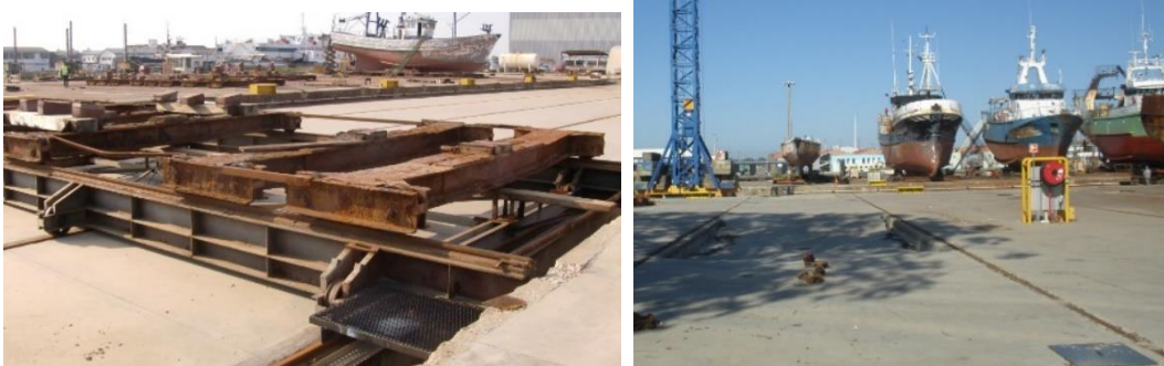
Figura 3.2- Plano horizontal – carro transfer e carreira de encalhe de navio, respetivamente.
