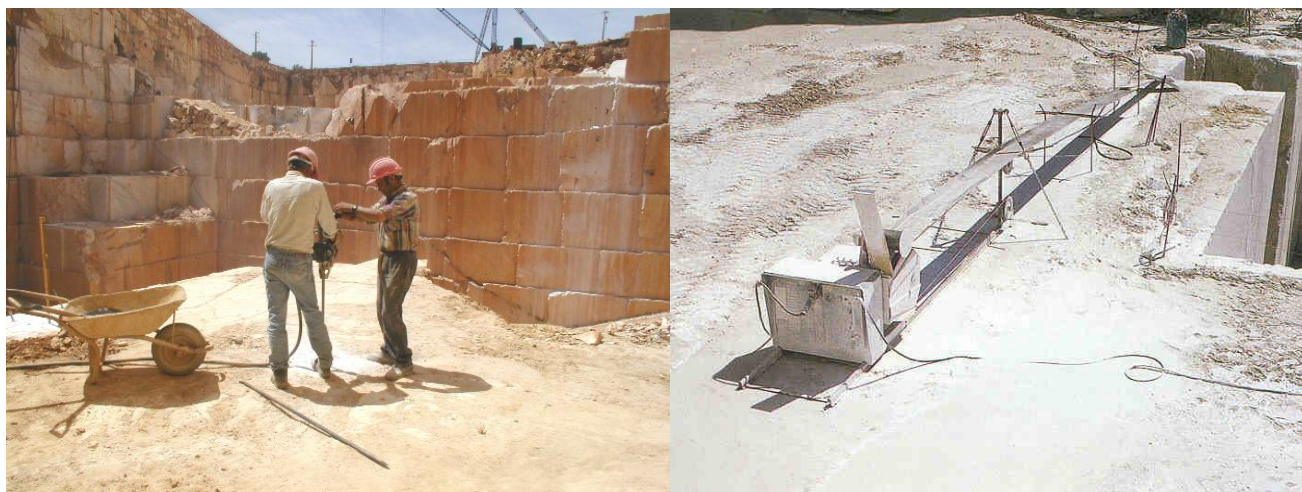
Figura 132. Operação de Perfuração e Corte numa pedreira de mármore.
