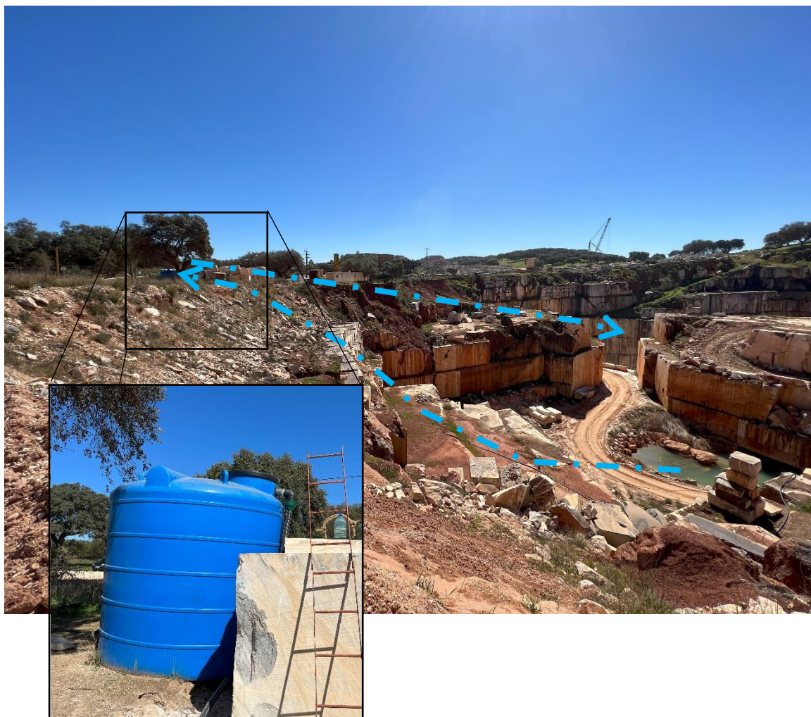
Figura 23. Captação e distribuição de água para fins industriais.
