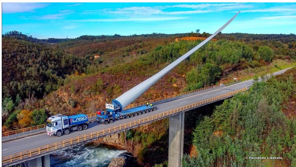
Fotografia 2.11 - Exemplo de veículo de transporte das pás eólicas (*Blade Lifter* da LASO).
