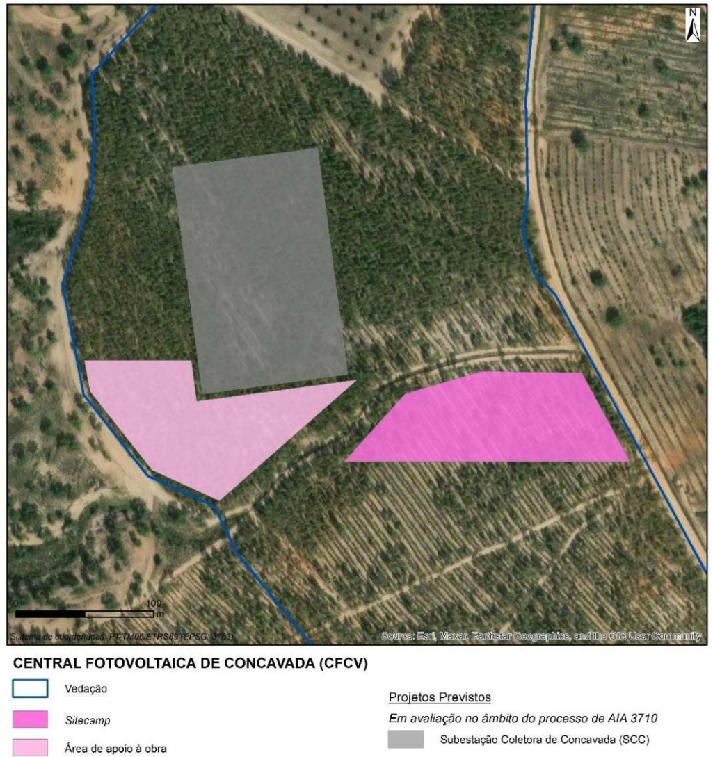
Figura 5.30 - Áreas de apoio à obra e Sitecamp (Estaleiro Principal) da CFCV
