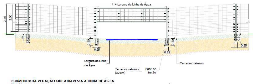
Figura 4– Exemplo de Esquema do atravessamento das linhas de água pela vedação (CFCV)
