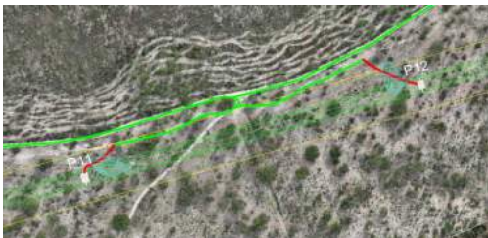
Figura 4.13 - Acessos aos apoios P11 e P12
