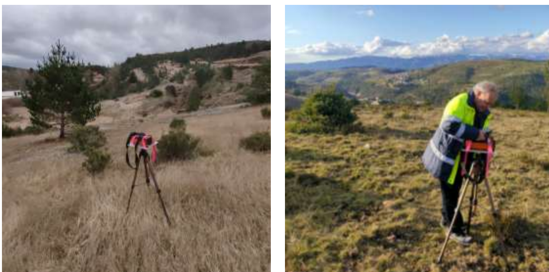
Figura 2 – Fotografias descritivas do protocolo de medição - tripé equipado com espectrómetro de raios-gama portátil a 1 metro do terreno.
