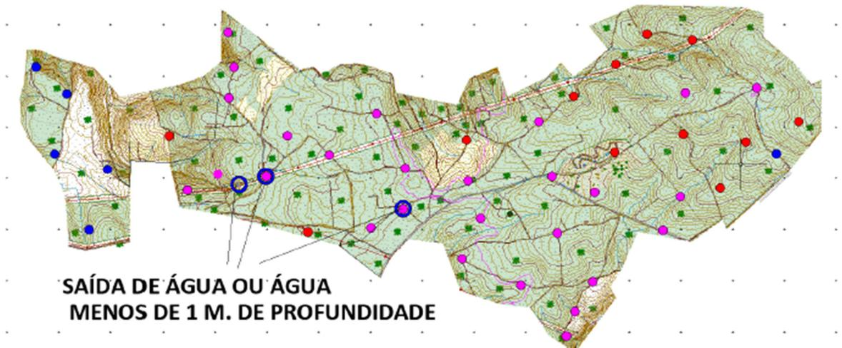
Figura 4.25 – Saída de caudal da espessura saturada, na área de implantação da central
