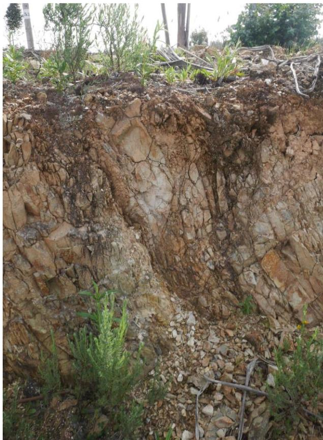
**Fotografia 12:** Neste talude é possível verificar a reduzida espessura do solo.
