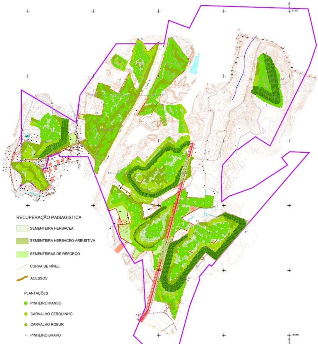
Figura 8– Desenho esquemático da recuperação paisagística.
