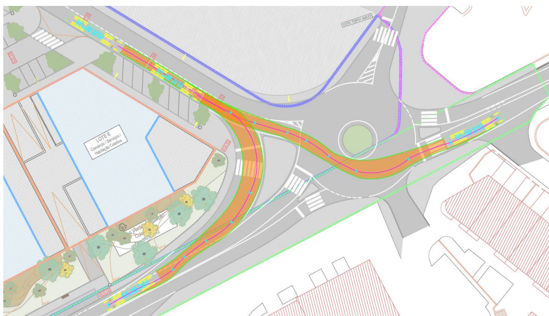
Figura II.3 - Simulação do percurso de saída, no nó 6, de um veículo de mercadorias (16,50 m)
