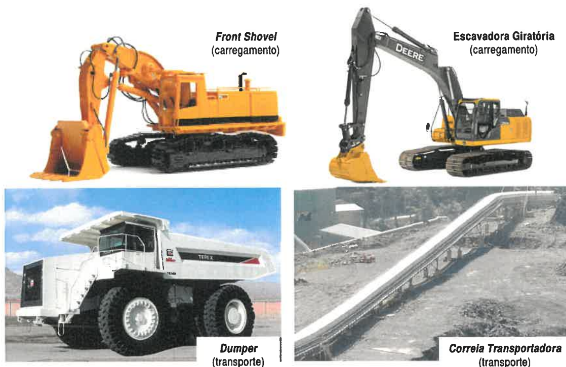
Figura 21 – Imagens exemplificativas dos equipamentos a utilizar nas operações de remoção e transporte do minério.
