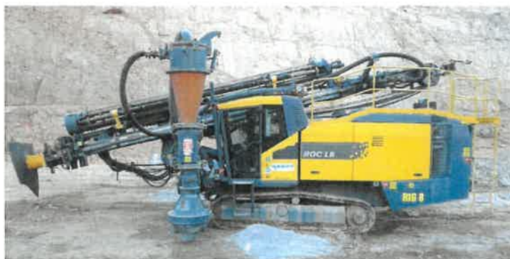
Figura 15 – Tipologia de equipamento a utilizar na operação de perfuração.
