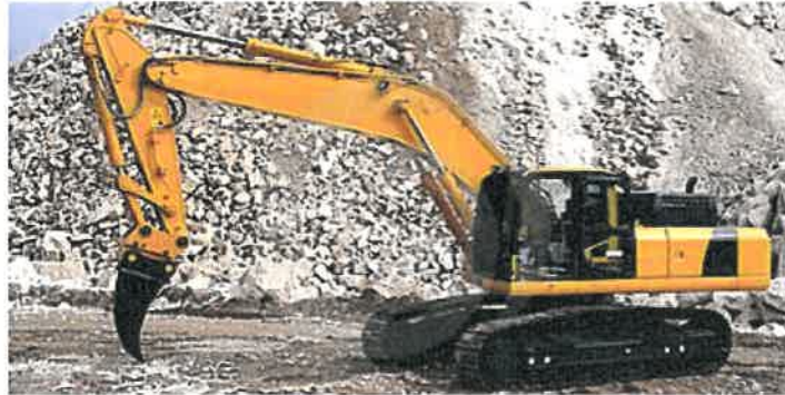
Figura 16 – Escavadora giratória equipada com ripper.
