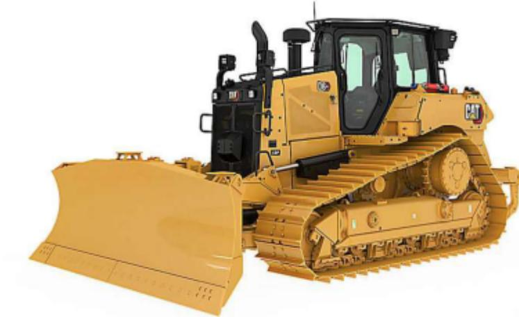
*Figura 6-6: Buldozer tipo CAT D6 da CATERPILLAR*
