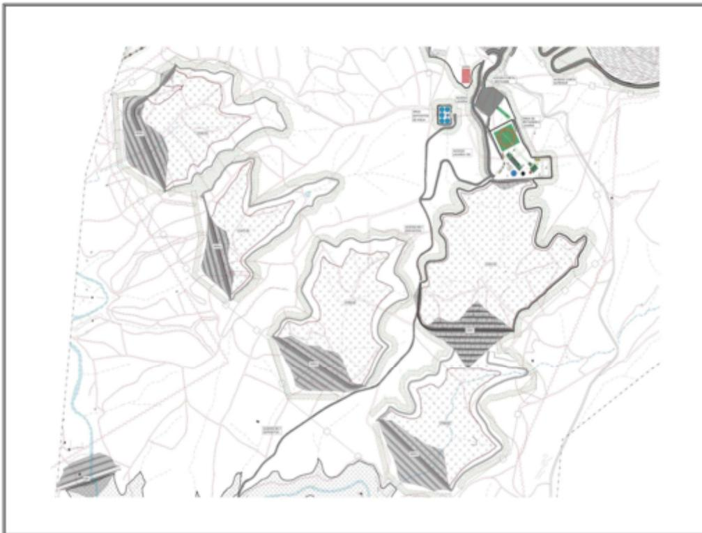
*Figura 7-10: Instalação de resíduos rejeitados 1,2,3,4 e 5 (IRR's)*
