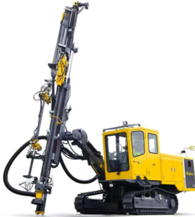
*Figura 6-1: Perfuradora FlexiROC T25 da EPIROC com cabine*
