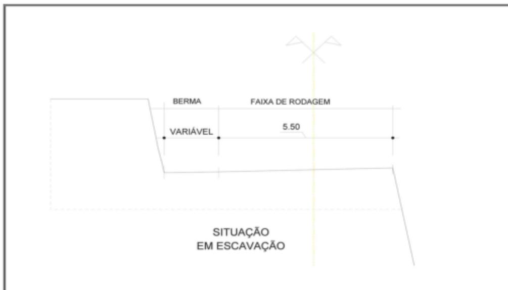
Figura 7-29: Perfil transversal tipo da rampa ao fundo da corta (RFC)
