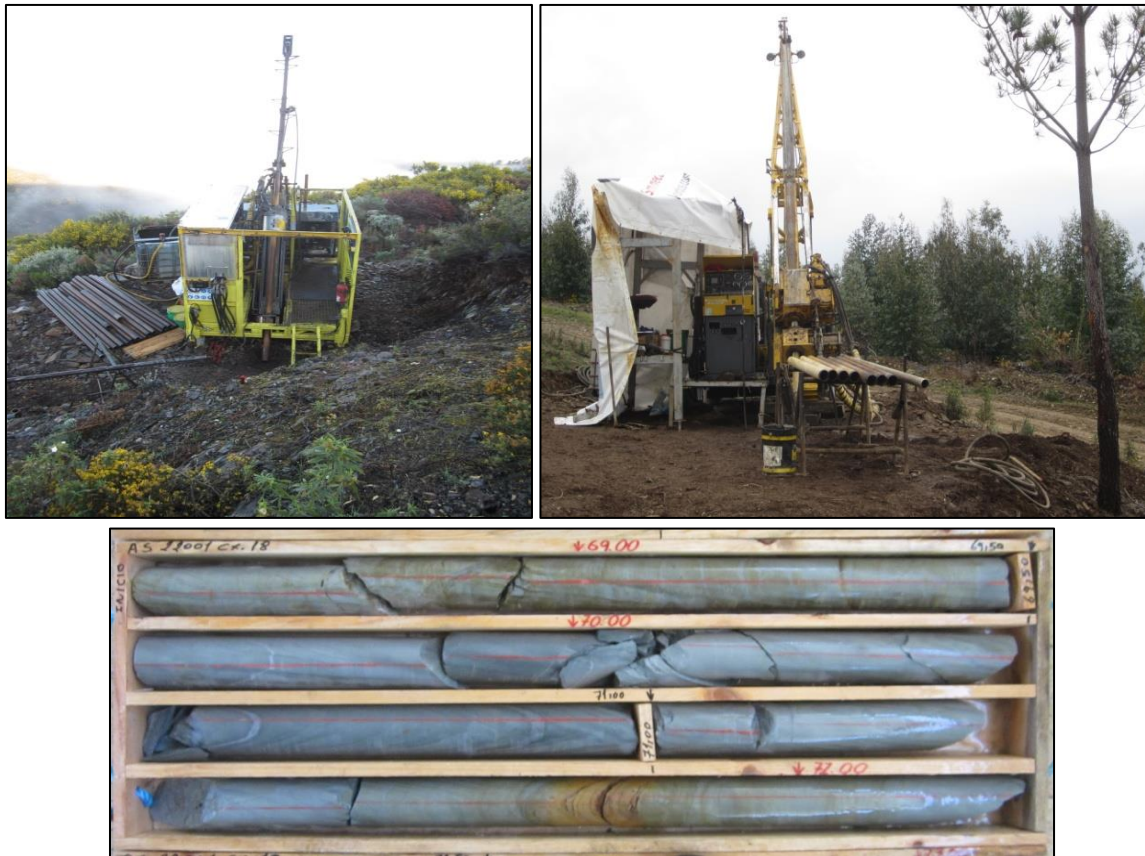
Figura 43 - Execução de sondagens referentes às duas campanhas de sondagens, entre 2011 e 2016 e testemunhos recolhidos
