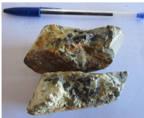
Figura 46 – Amostra obtida de uma carote de sondagem com um filão mineralizado, onde são evidentes dos cristais de cassiterite de cor cinza-escuro
