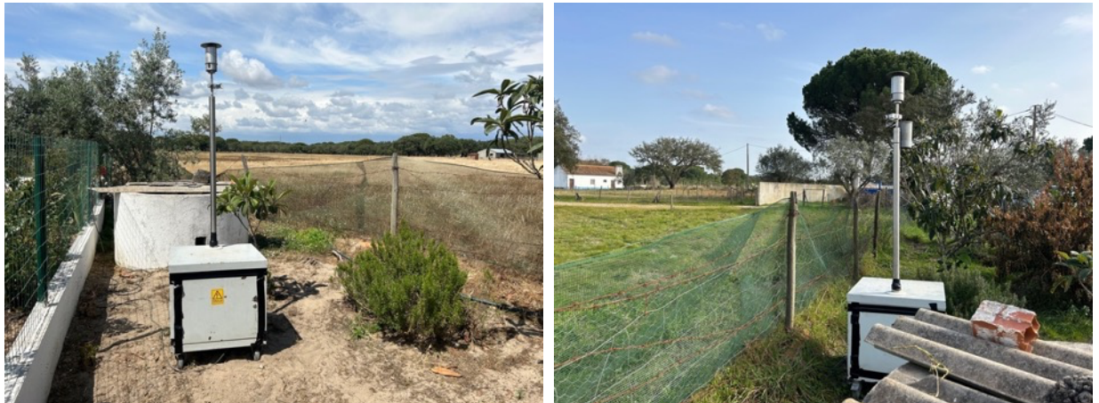
Figura 5 – Perspetiva do equipamento de medição da qualidade do ar durante as medições realizadas no local de medição P2.
