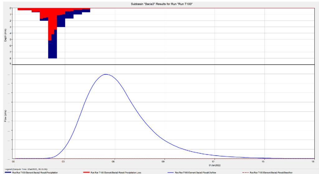
Figura 3.13 – Exemplo de hietograma e hidrograma de cheia de uma bacia da área em estudo
