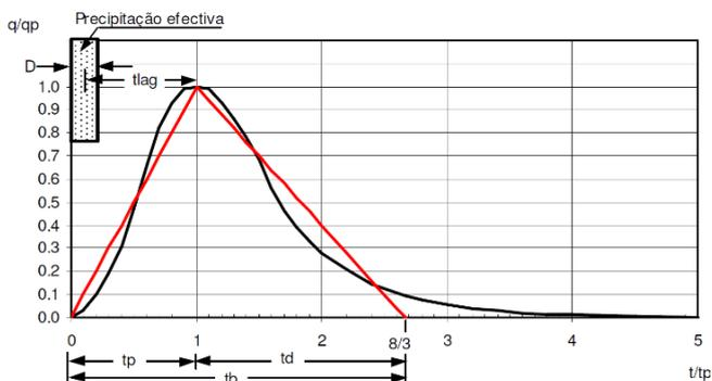
Figura 3.11 - Hidrograma unitário sintético do Soil Conservation Service, SCS, e correspondente hidrograma triangular (Portela, 2000)
