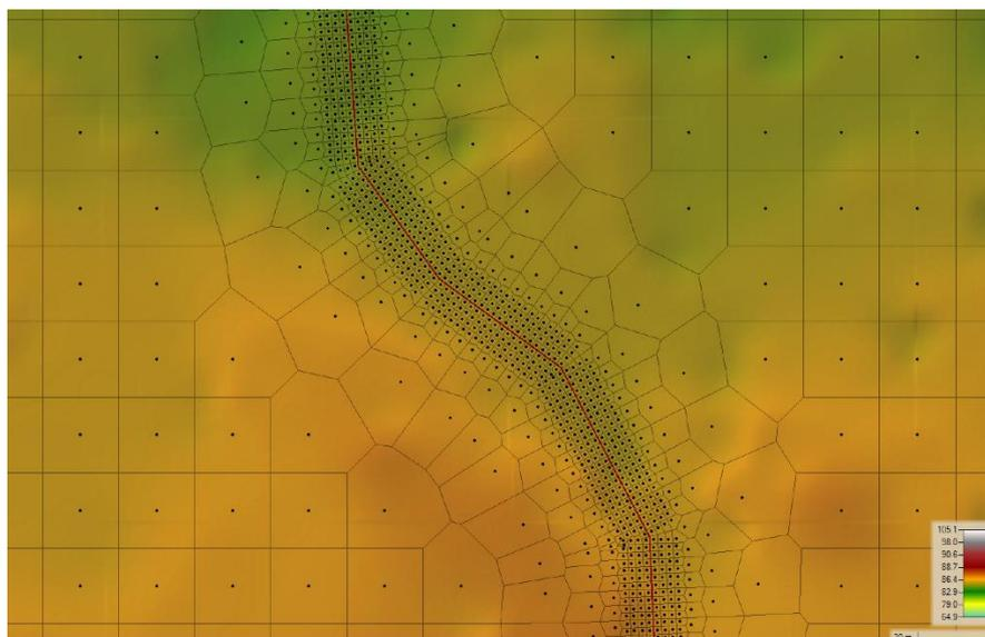
Figura 4.5 – Detalhe da malha de cálculo utilizada no modelo 2D
