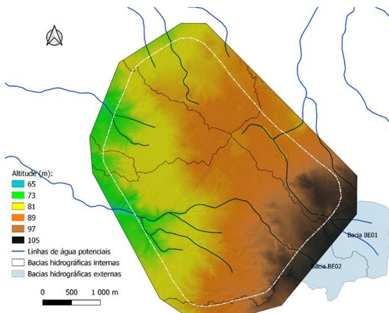
Figura 3.2 - Bacias hidrográficas externas, que escoam para o interior da área do projeto.
