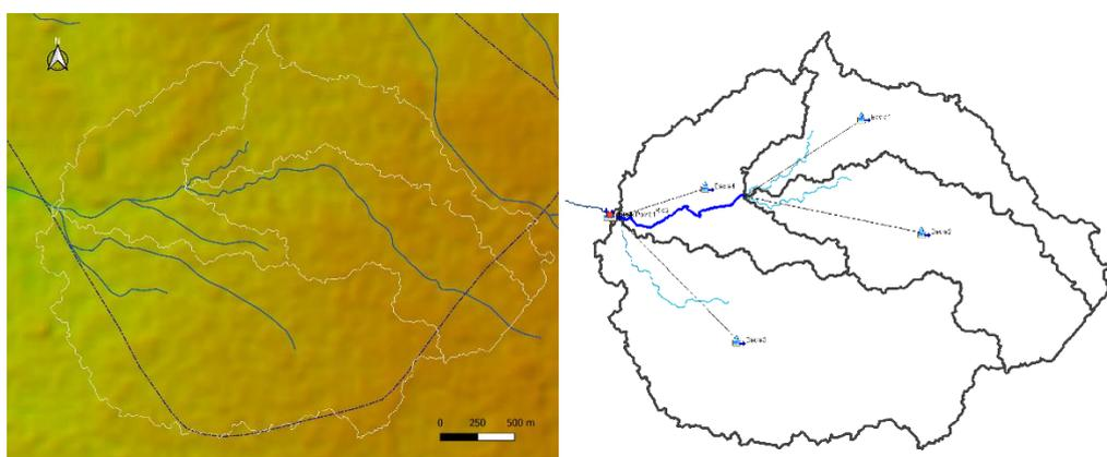
Figura 3.9, a) e b) – Linhas de água da bacia interna 1, e divisão em sub-bacias, em modelo SIG a) e no modelo HEC-HMS b).
