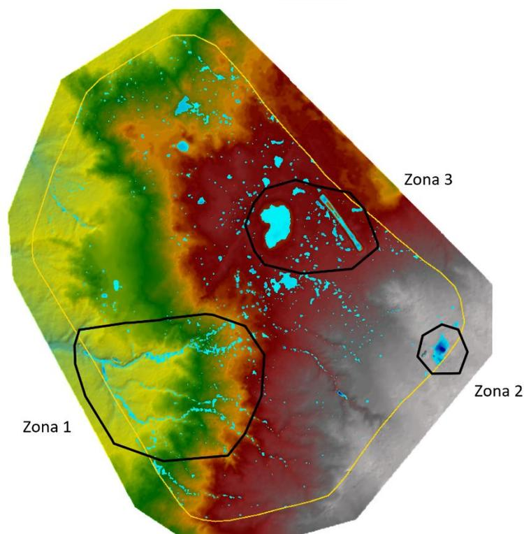
Figura 5.1 – Principais zonas de escoamento/armazenagem de água.
