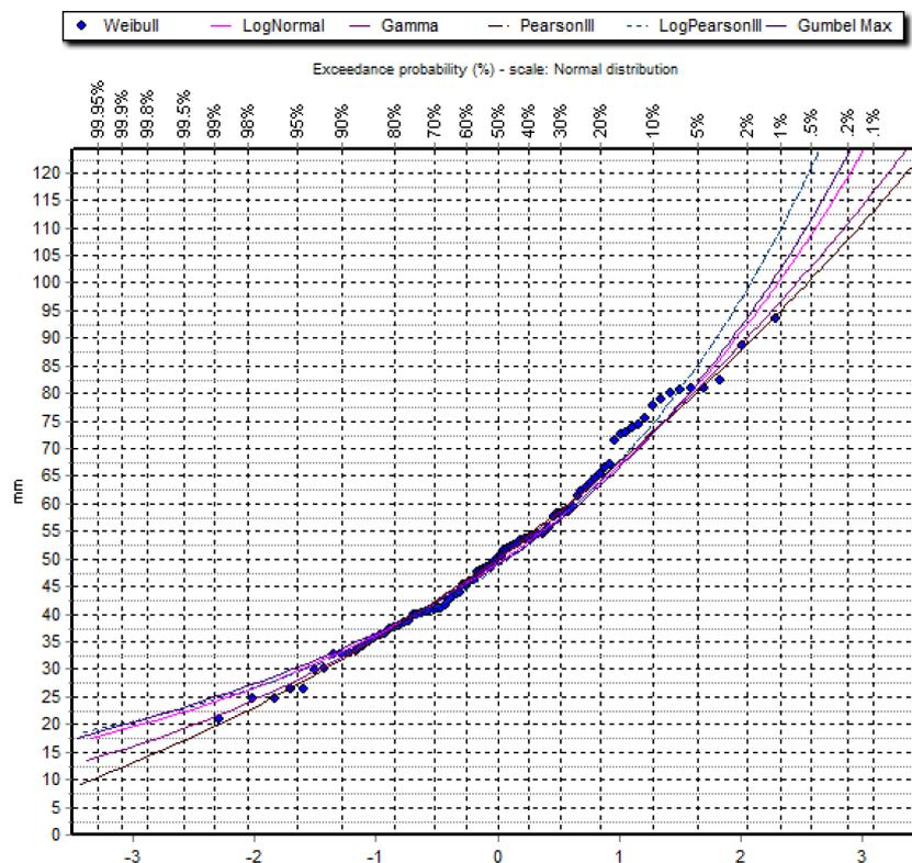
Figura 3.7 – Gráfico da probabilidade de excedência das várias distribuições estatísticas.
