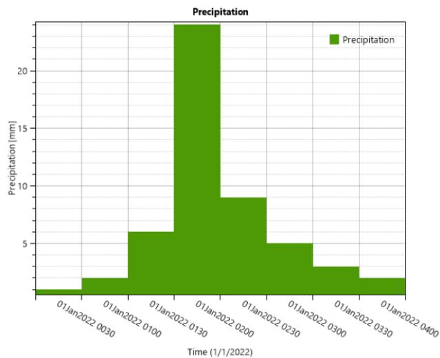
Figura 4.7 – Hietograma para T=100, da área interna do terreno em estudo obtido no software (semelhante ao da fig. 2.6)
