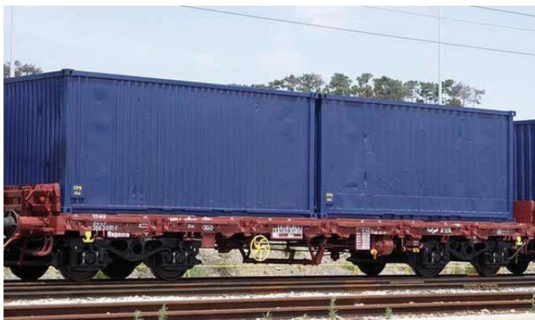
**Figura 6-7 – Fotografia de um vagão Regmms 32943563, com balaústres rebatíveis**
