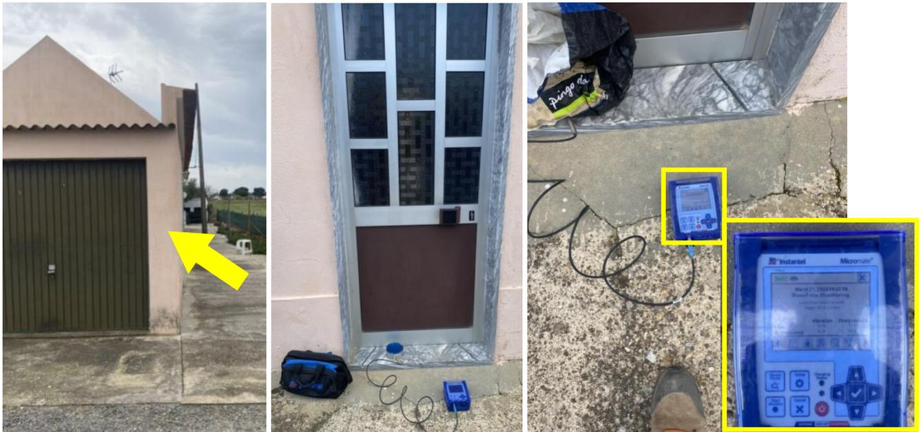
Figura 5. Aspectos da estrutura monitorizada e instalação do sismógrafo, com o respectivo geofone (ponto 1)
