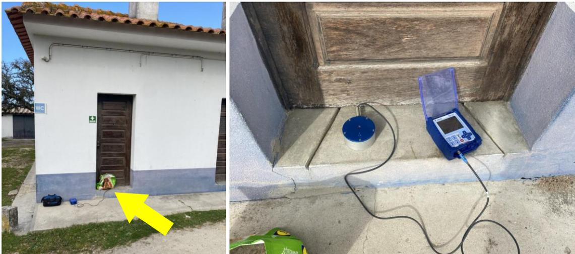
Figura 11. Aspectos da estrutura monitorizada e instalação do sismógrafo, com o respectivo geofone (ponto 3)
