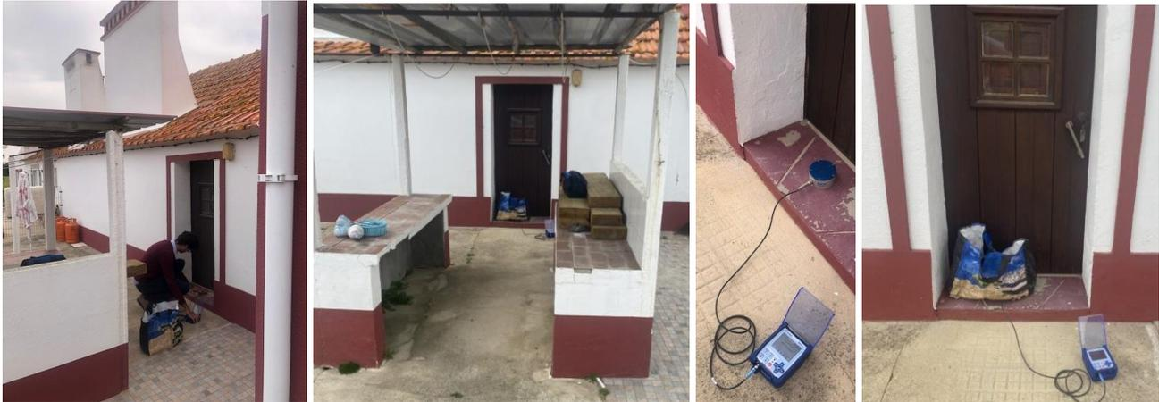
Figura 14. Aspectos da estrutura monitorizada e instalação do sismógrafo, com o respectivo geofone (ponto 4)
