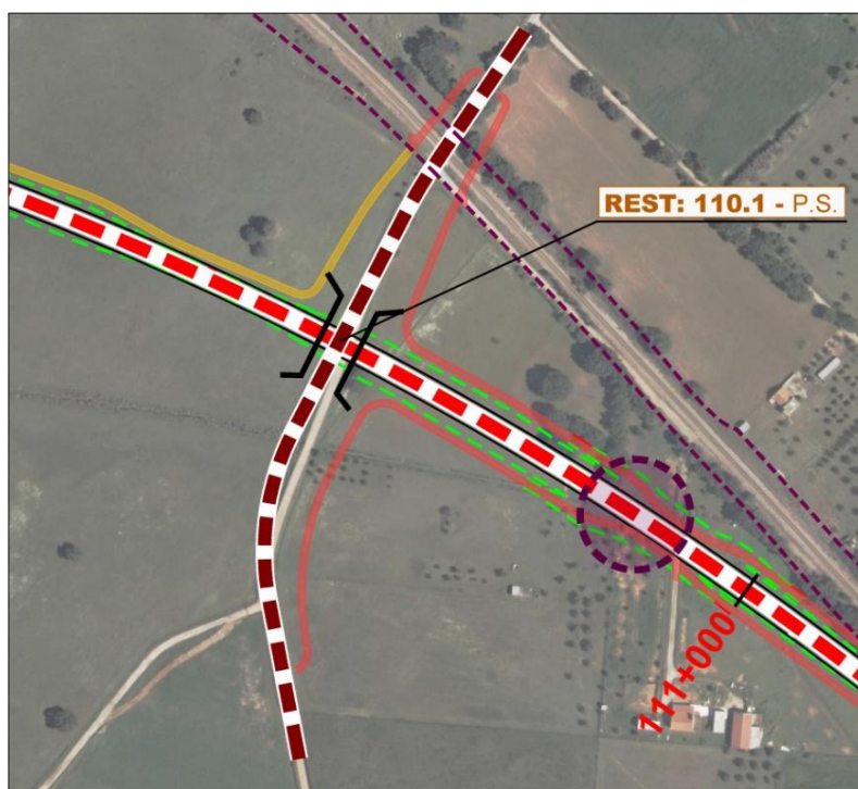
Figura 8 - Restabelecimento do acesso à habitação localizada na envolvente do Km 111+040
