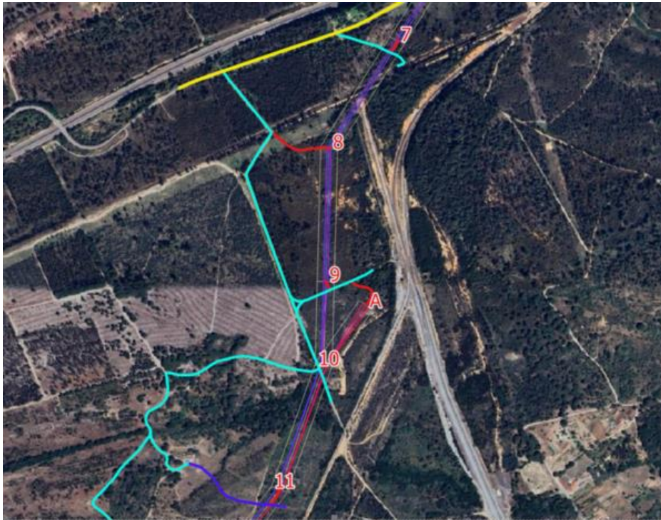
Figura 3.10 – Planta de acesso aos apoios 8, 9, 10, A e 11
