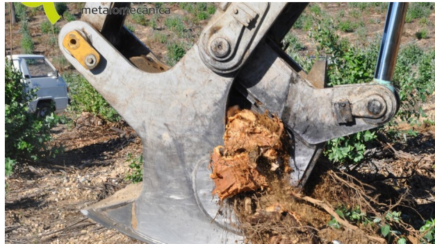
Figura 3 - Arranque e destruição de toijas com RAC
