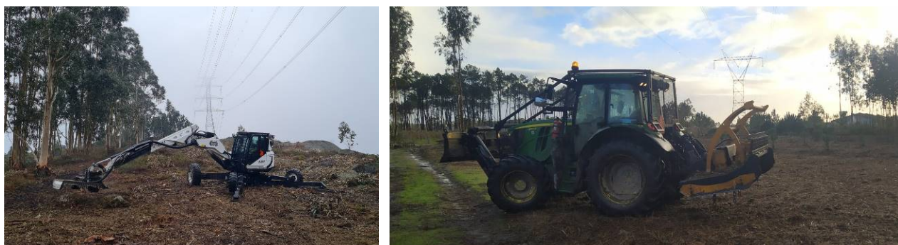
Figura 38 - Limpeza de matos mecânica: corta-matos de correntes, acoplado a retro-aranha e a trator florestal
