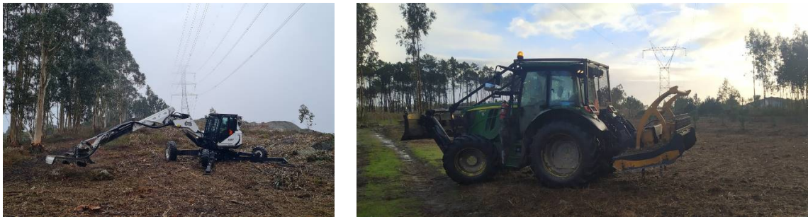
Figura 6 -corta-matos de correntes, acoplado a retro-aranha e a trator florestal
