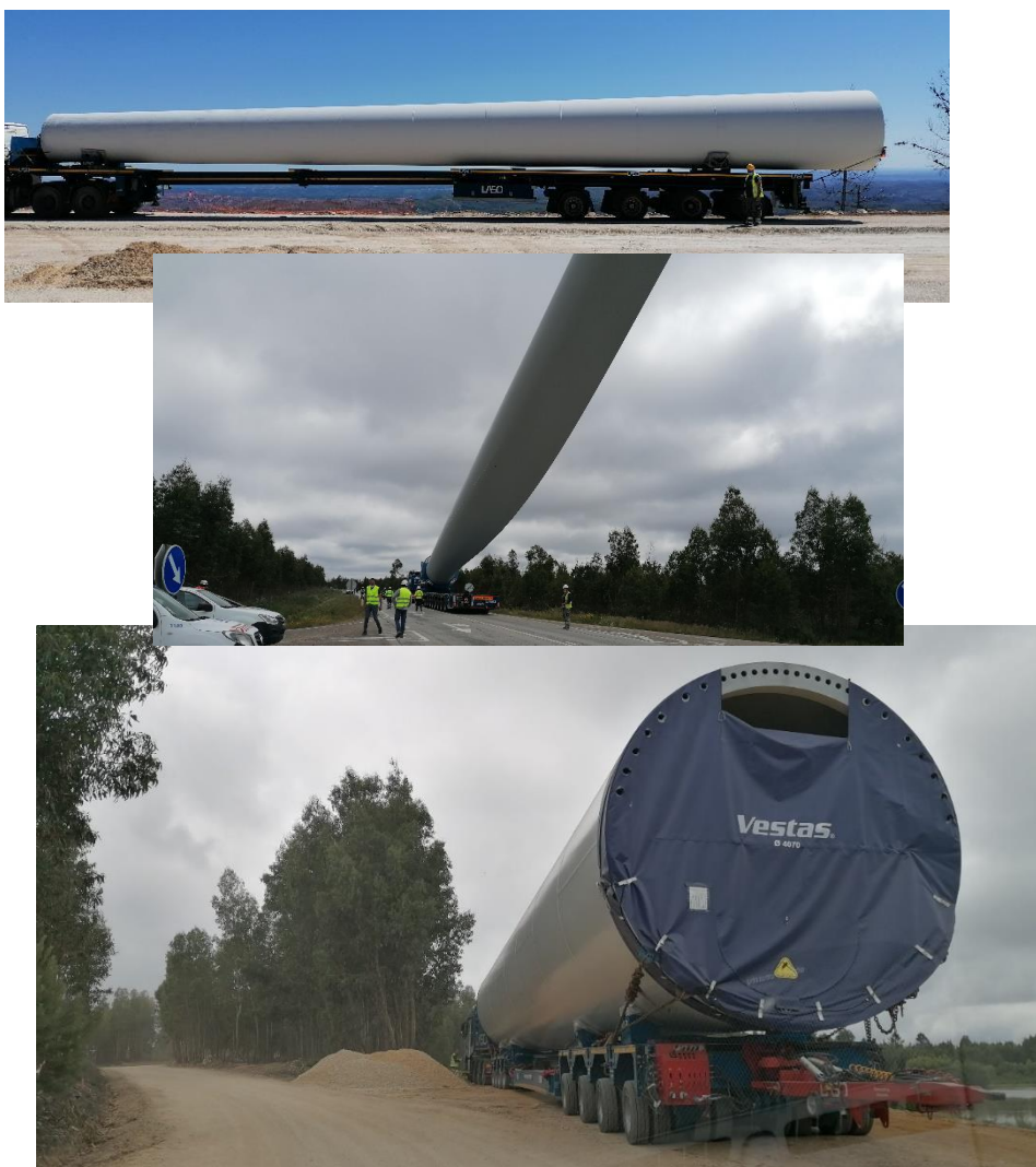
Fotografia 5 – Transporte das pás dos aerogeradores (exemplificativo).
