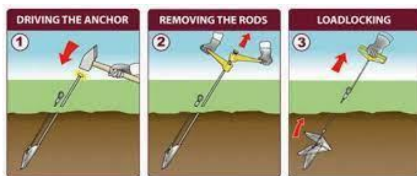
Figura 22: Esquema de instalação de âncoras
