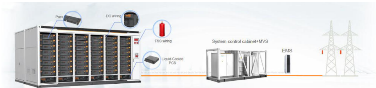
Figura 4.4 – Ligação do BESS à rede elétrica
