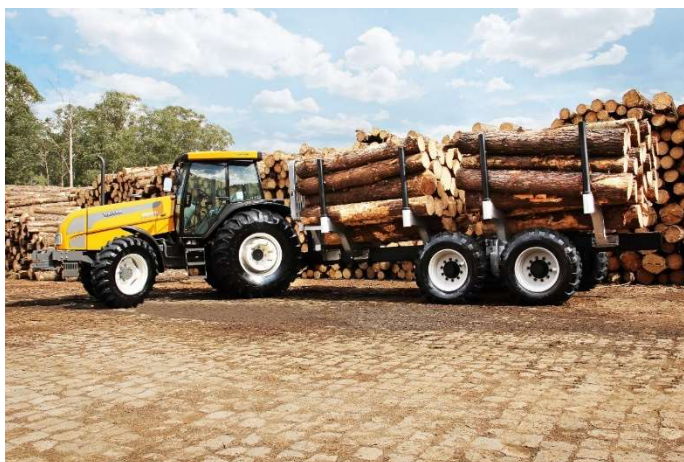
Foto III. 2 – Trator com Reboque e Grua
