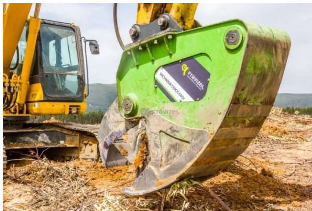
Foto III. 6 – Escavadora Hidráulica Com Pinça ou Rachador Arranca Cepos
