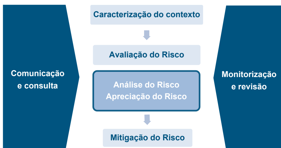
Figura 3.1 – Processo geral da gestão de risco (adaptado da Norma ISO 31000:2018).
