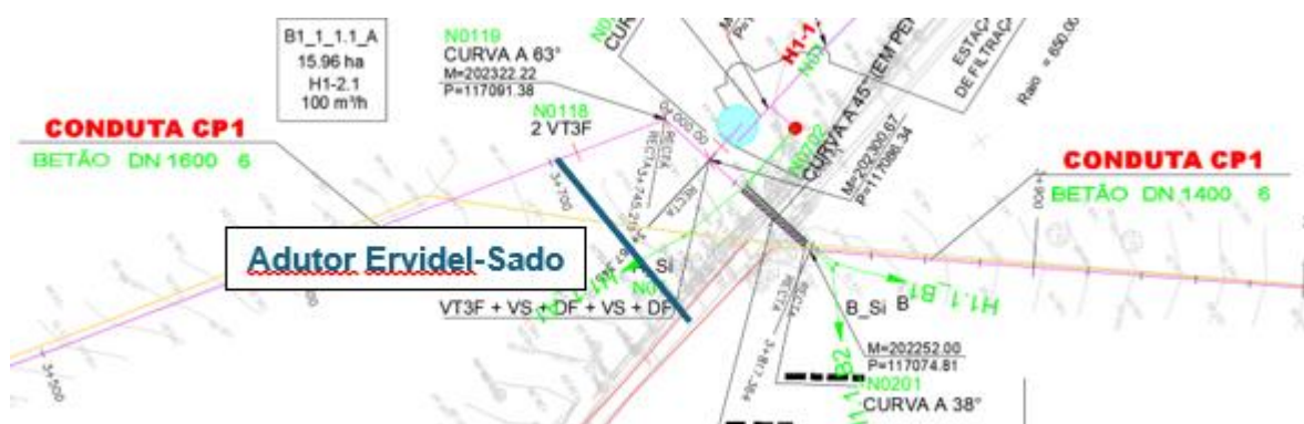
Figura 3.2 – Início do adutor junto à derivação para a conduta C1.1
