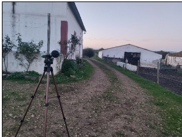
Foto 1. – Ponto de Medição de Acústica P1 – localizado junto de habitação unifamiliar (1 Piso) pertencente a Quinta agrícola isolada a cerca de 1200 m a Norte/Poente do da Reactância Shunt do Posto de Corte do Pego (Coordenadas Google Earth em graus decimais: Lat.: 39.462846°; Long.: -8.123895 °).
