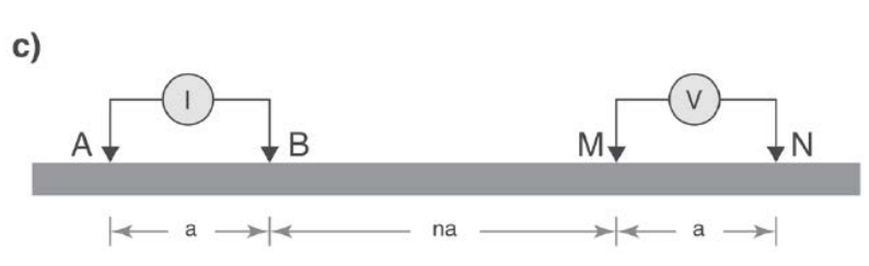
Figura 5.13 - Dispositivo de Dipolo-Dipolo (adaptado Sheriff, 1990).
