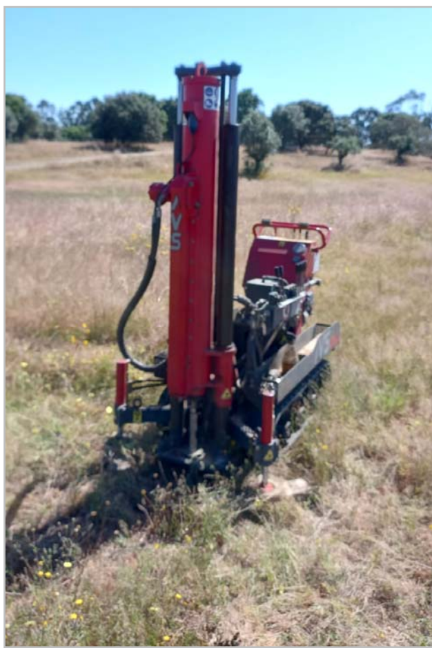
Figura 5.5 - Equipamento utilizado para a execução dos ensaios DPSH (DPSH3).
